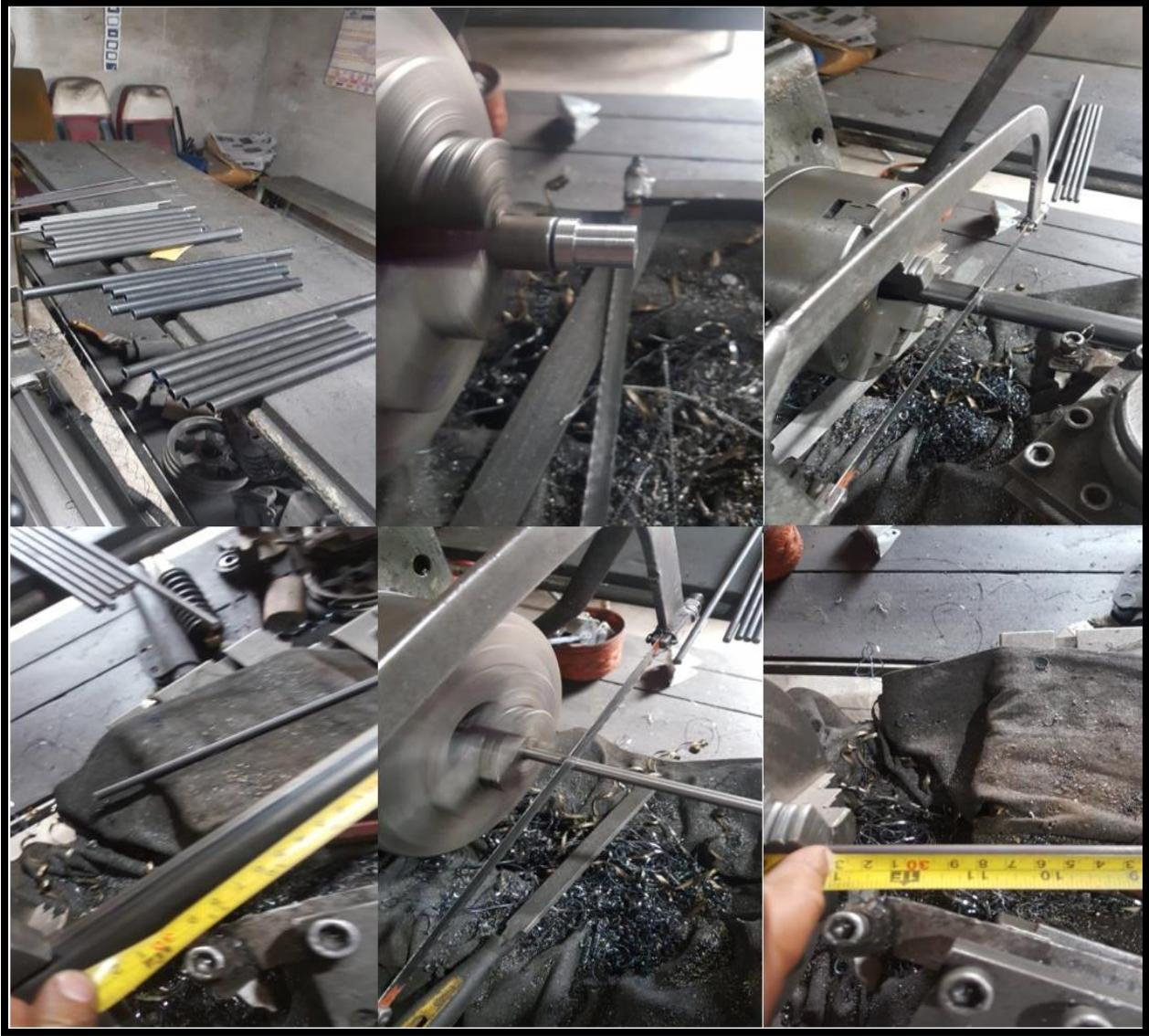
Anexo 7. Realización de Probetas circulares y varillas.
