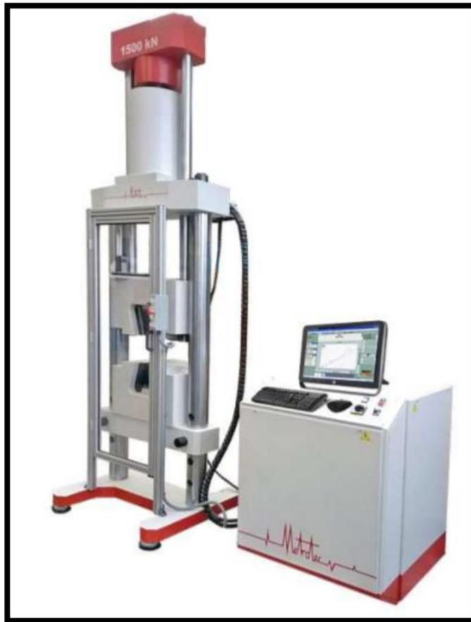
Figura 17. Maquina Ensayo de tracción. Tomado de: (CFPMM. 2019).
