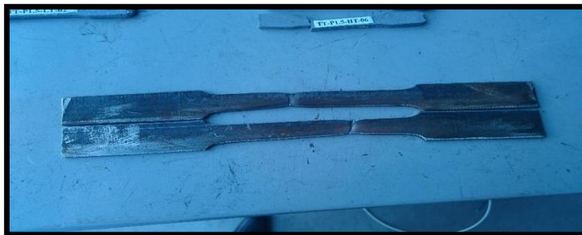
*Figura 44.* Fisura del Material Plano. Tomado de: (CFPMC. 2018).
