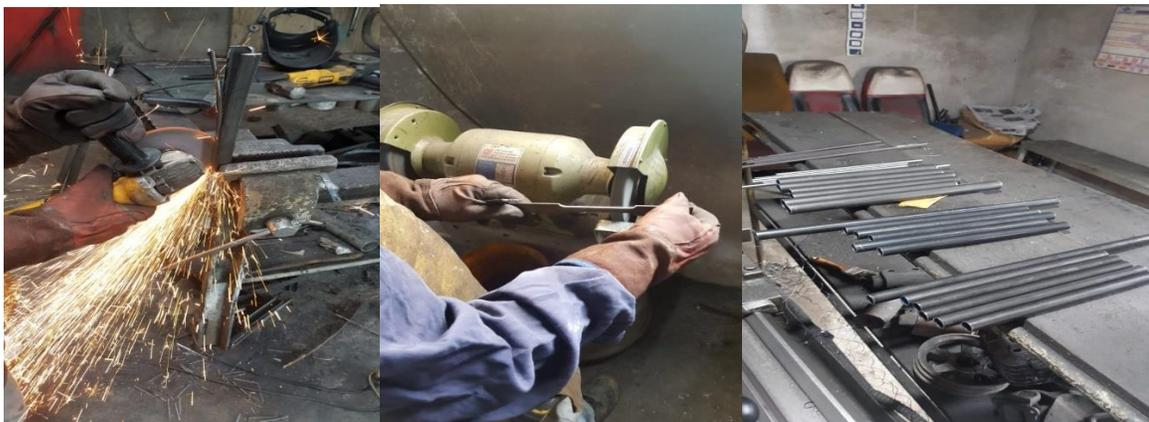
Figura 35. Proceso de realización de probeta. Tomado de: (ITSG. 2018).
