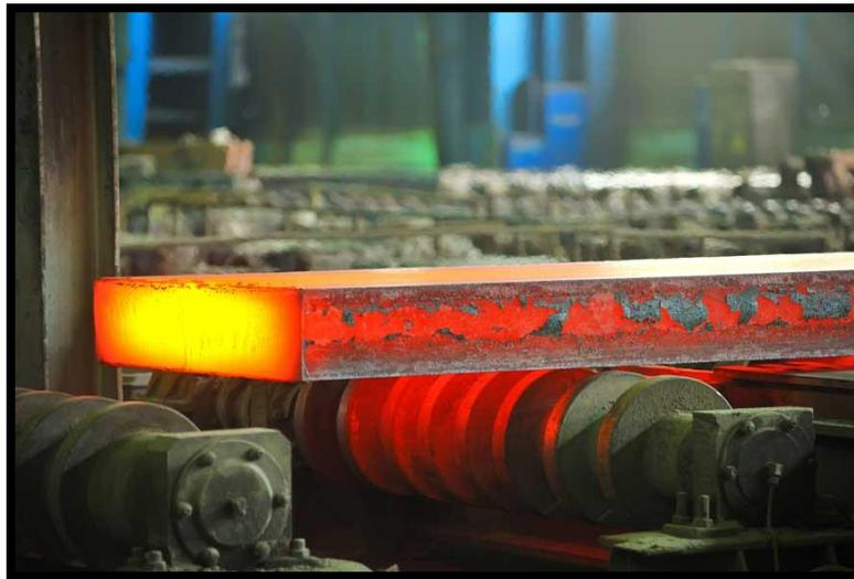
*Figura 12.* Acero Laminado en caliente. Tomado de: (AMA, 2016).
