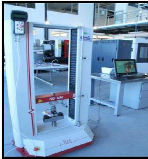
*Figura 38.* Máquina de Ensayo Universal. Tomado de: (CFPMC. 2018).
