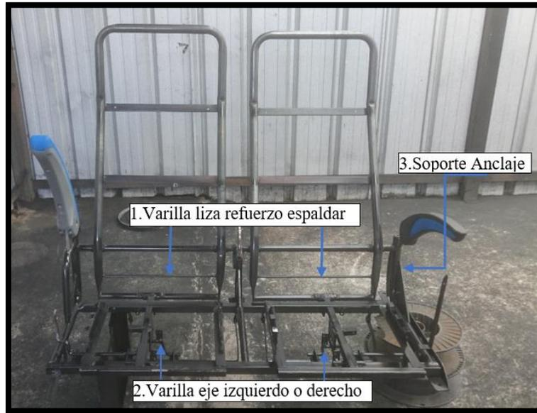
Figura 29. Varillas y Soporte Anclaje. Tomado de: (IMEISA 2019).
