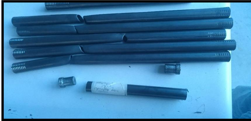
*Figura 45.* Fisura del Material circular. Tomado de: (CFPMC. 2018).
