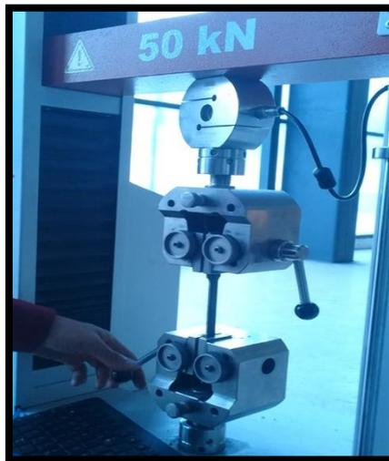
Figura 40. Sujeción de la probeta. Tomado de: (CFPMC. 2018).
