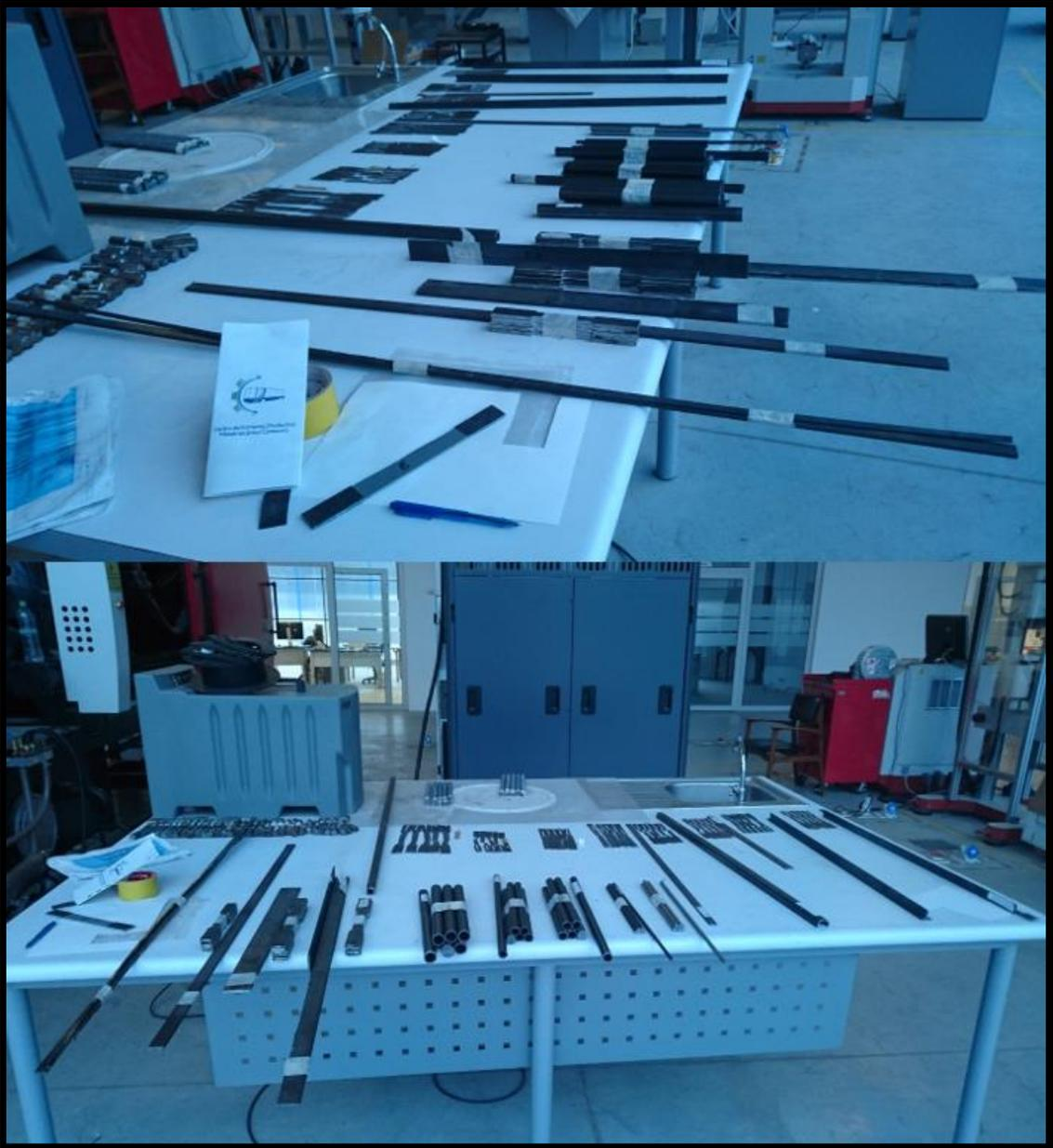
*Anexo 15. Designación de códigos con nombres a todas las probetas para ensayos de tracción.*
