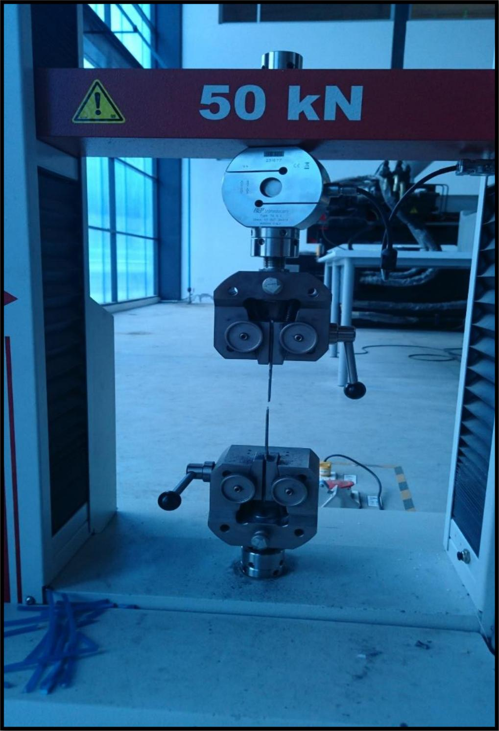
*Anexo 17. Equipo de ensayo de tracción.*
