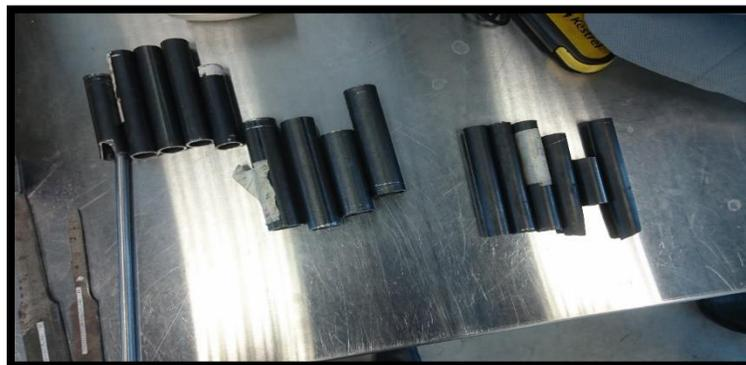
*Figura 37.* Probetas para ensayo de densidad. Tomado de: (CFPMC. 2018).
