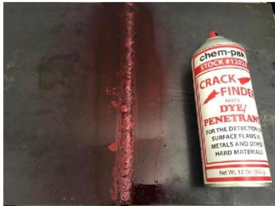
*Figura 16. Tintas Penetrantes Líquido Penetrante Utilizado En La Inspección De Las Placas De Donde Saldrán Las Probetas.*
