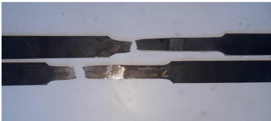
*Figura 35. a) Especímenes Con Proceso GMAW (MIG/MAG) Electrodo ER70S-6, b) Especímenes Con Proceso SMAW Electrodo E6011, Material Base ASTM A36.*
