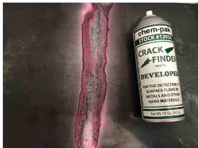
*Figura 17. Tintas Penetrantes Líquido Revelador Utilizado En La Inspección De Las Placas De Donde Saldrán Las Probetas.*
