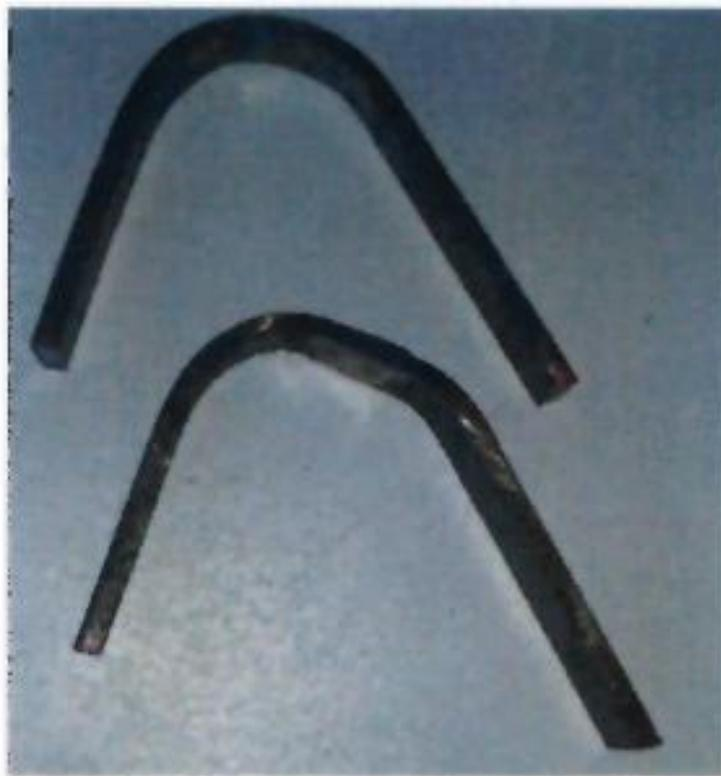
**Figura 42.** Especímenes Con Proceso GMAW (MIG/MAG) Electrodo ER70S-6,
