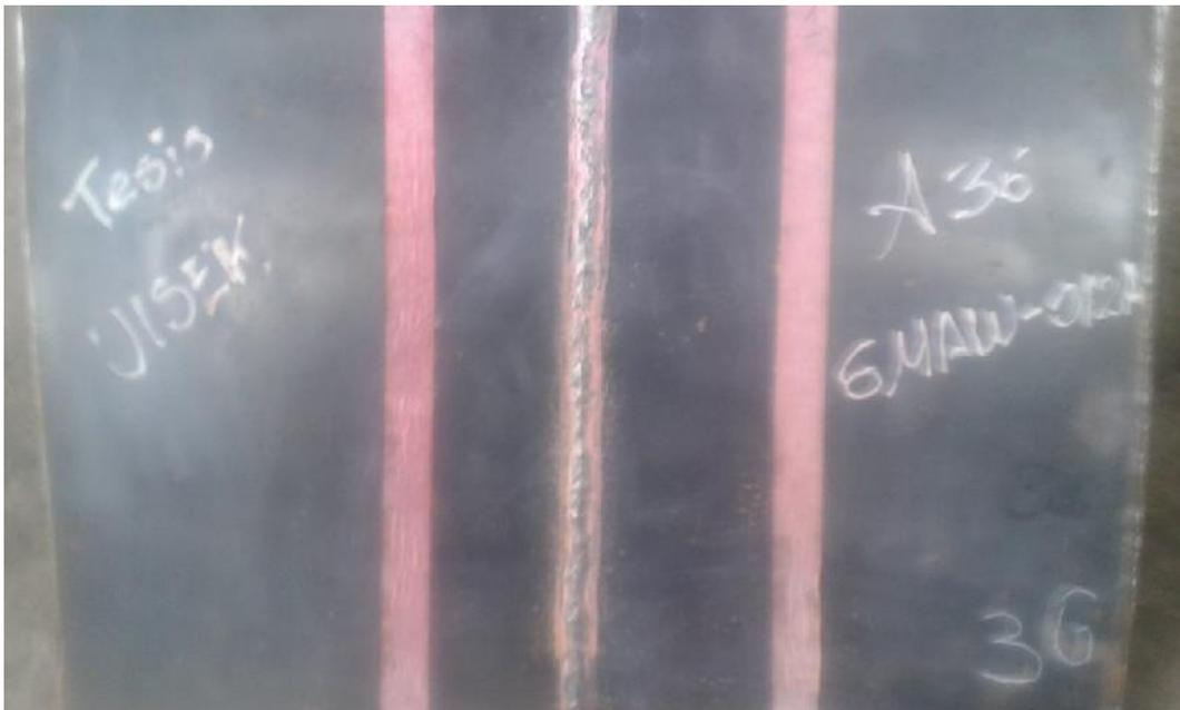
**Figura 30.** Placa base con proceso GMAW Material ASTM A-36
