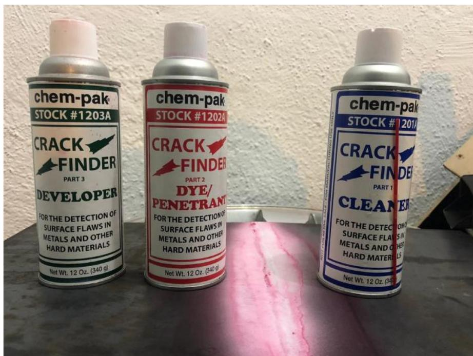
*Figura 14. Tintas Penetrantes Utilizadas En La Inspección De Las Placas De Donde Saldrán Las Probetas.*
