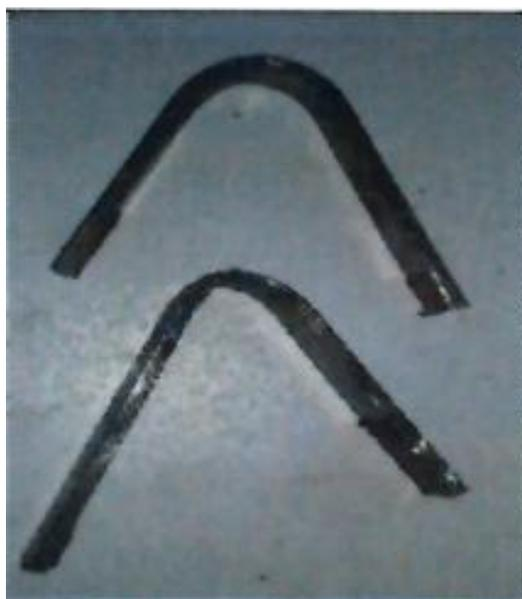
**Figura 41.** Especímenes Con Proceso SMAW Electrodo E6011, Material Base ASTM
