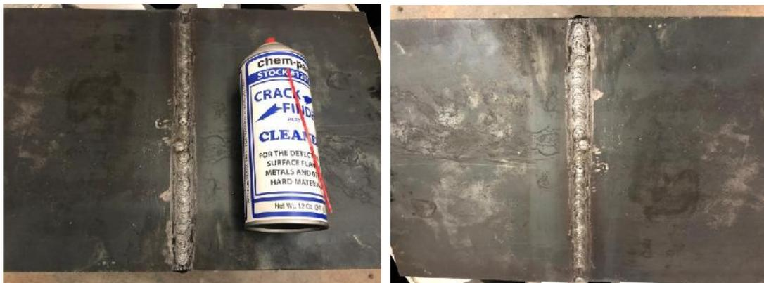
*Figura 15. Tintas Penetrantes Líquido Limpiador Utilizado En La Inspección De Las Placas De Donde Saldrán Las Probetas.*
