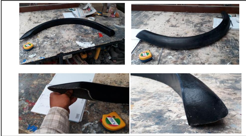
Figura 22. Proceso de construcción del fender flares delantero
