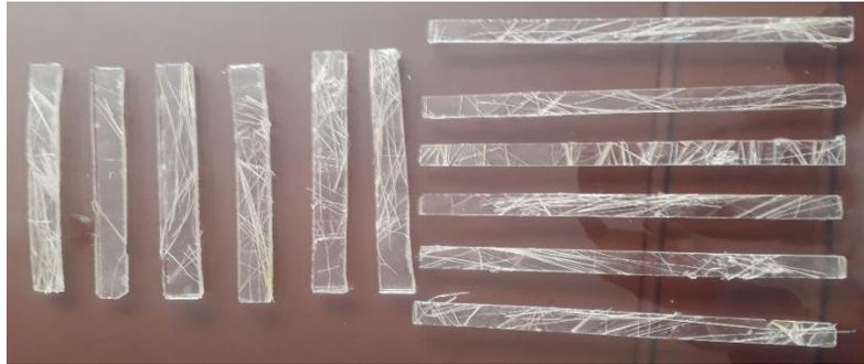
Figura 12. Probetas fibra tejida
