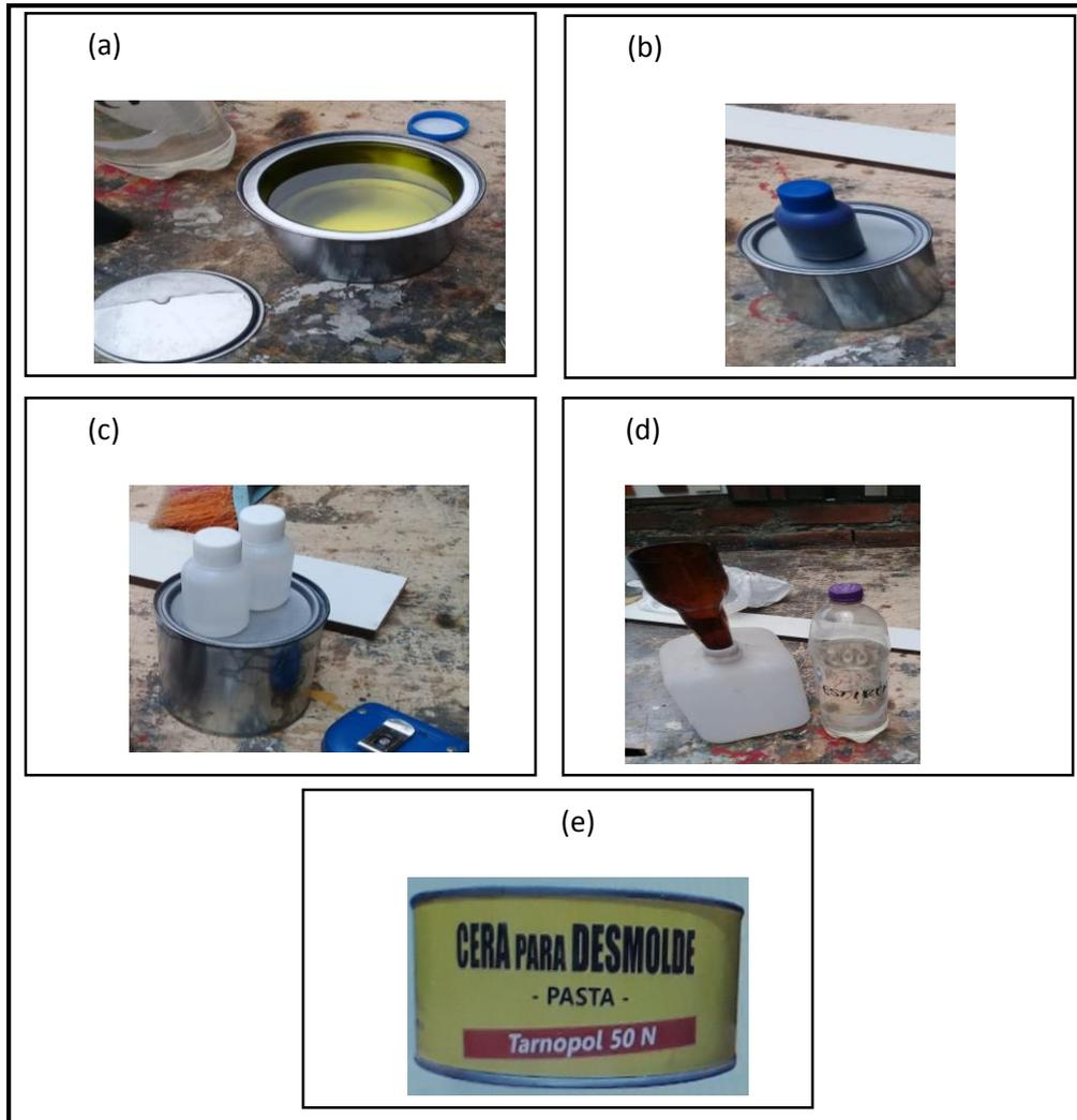
Figura 18. Materiales para la fabricación de las probetas (a) resina de poliéster Basf Palatal A430, (b) Octoato de cobalto, (c) Peróxido MEK, (d) Estireno y (e) Cera desmoldeante.
