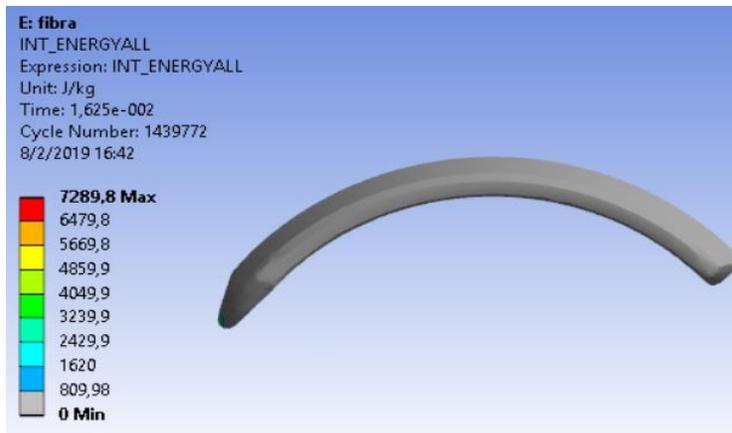
*Figura 59.* Simulación energía interna fender flares, resina de poliéster
