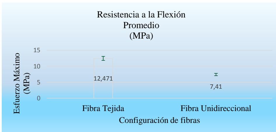
Figura 46. Comparación de la media del esfuerzo máximo promedio por el método LSD de Fisher
