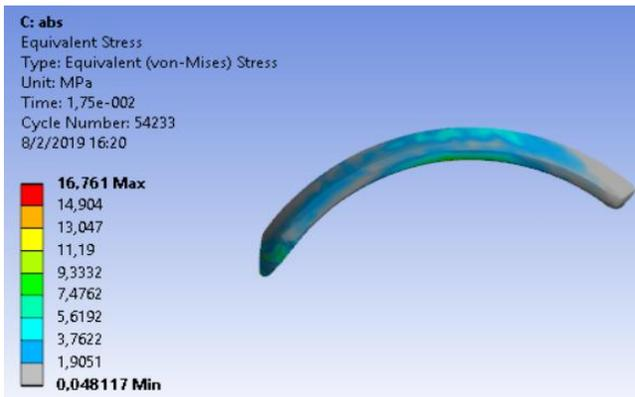
Figura 63. Simulación esfuerzo máximo fender flares, material ABS
