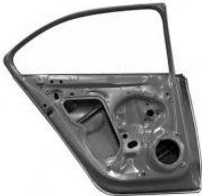
Figura 15: Estructura interna de la puerta
