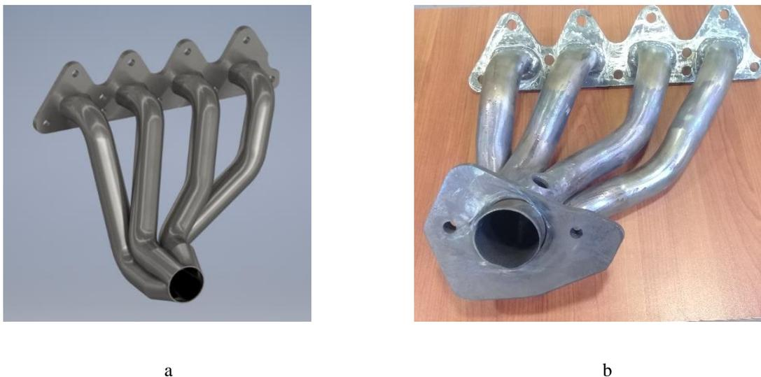
Figura 29. Múltiple de escape 4-1: (a) modelado 3D, (b) real
