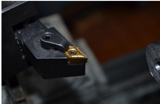
Figura 40. Instalación del inserto en el herramental.
