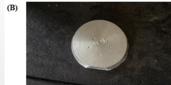
Ensayo de dureza rockwell B. (A) medición a través del penetrador de bola y (B) huellas dejada por la presión del penetrador.
