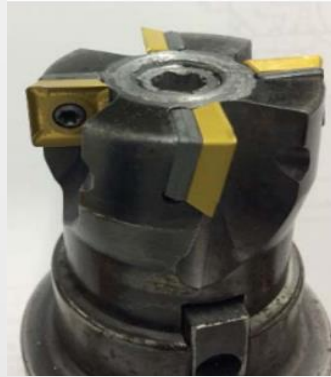
Fresas de carburo 4 flancos Marca Sandvik
