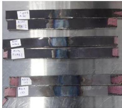
Figura 27. Probetas para Ensayo de Flexión acero ASTM A36, A514 y A517 (CFPMC).
