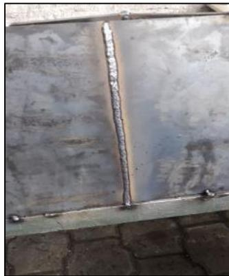
Ejecución de cordón de soldadura en posición 3G Descendente
