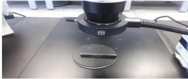
*Figura 23.* Ensayo de Macrografía Transversal (CFPMC).
