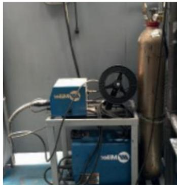
*Figura 15.* Soldadora marca Miller XMT Serie 350 (Taller de Soldadura Master TAC)
