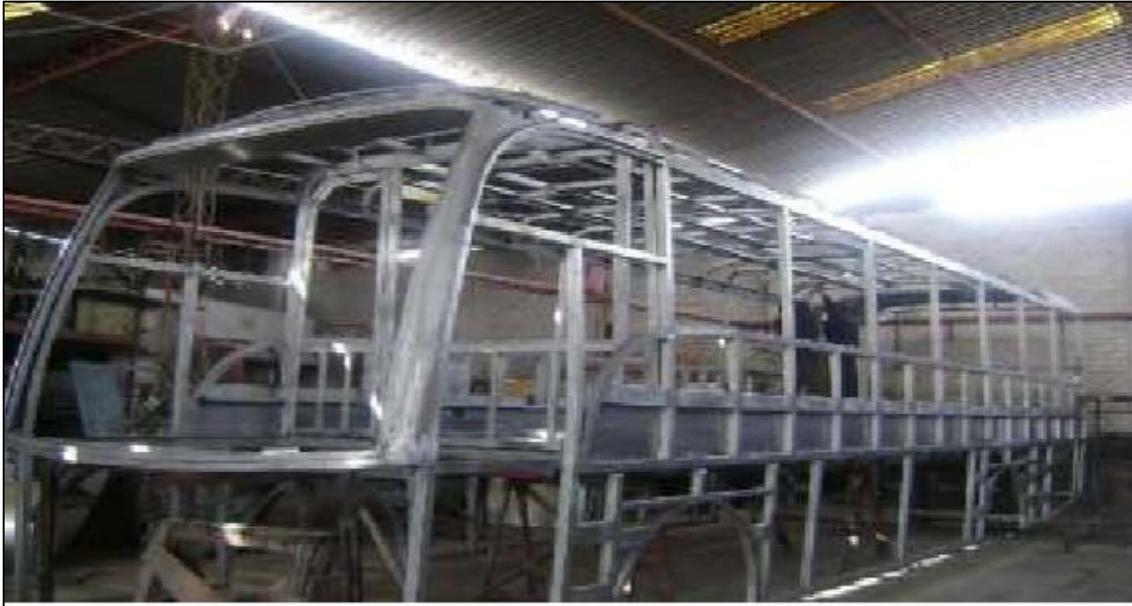
Estructura metálica, Carrocería para un Bus Interprovincial.
