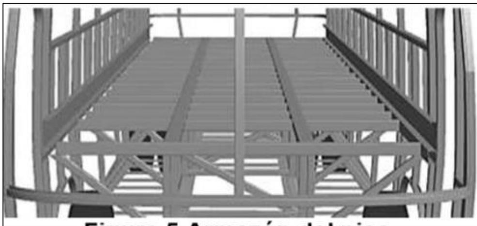
Armazón del piso de una Carrocería Terminada
