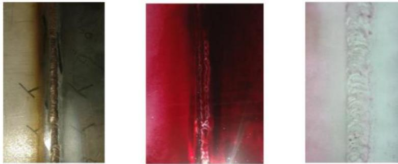
*Figura 13.* Aplicación de Tintas Penetrantes (ASTM E165 / E165M).
