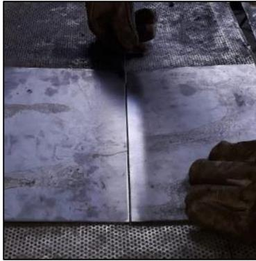
Seccionamiento (ranura cuadrada) y limpieza de partes a ser soldadas
