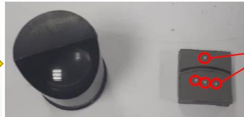
Figura 5. Lupa para medición y muestra con las deformaciones aplicadas
