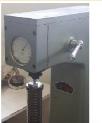
Figura 4. Ensayo de Dureza Brinell
