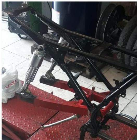
*Figura 64.* Montaje de la suspensión.
