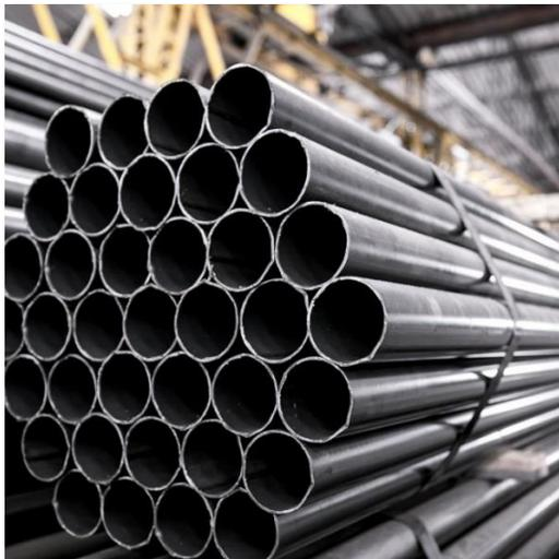
Figura 56. Tubería mecánica redonda ASTM A36.
