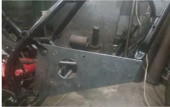
*Figura 59.* Placa base del motor eléctrico.
