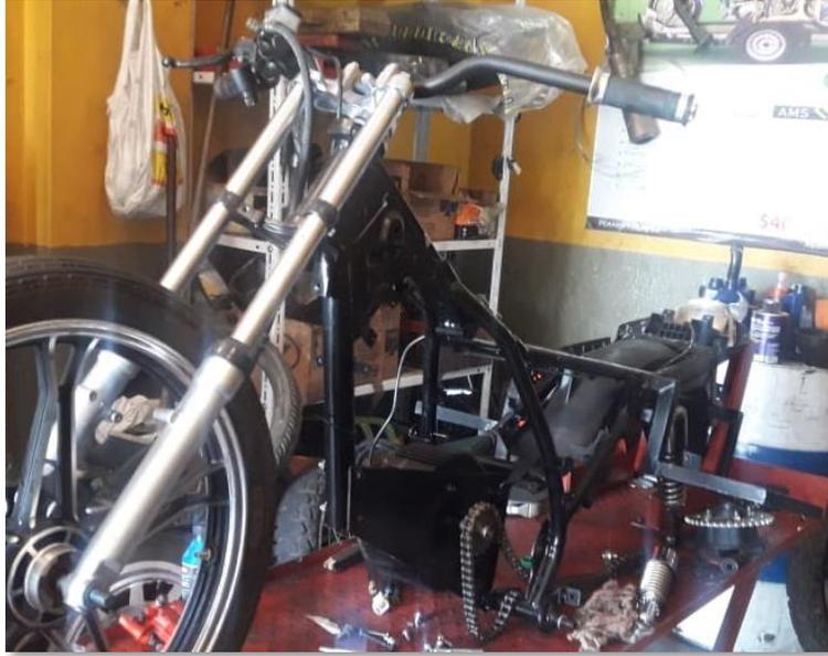
*Figura 63.* Montaje de la dirección.
