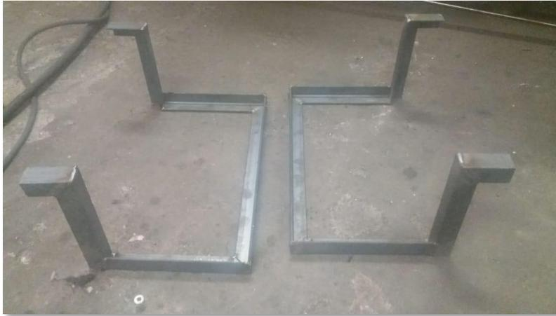
*Figura 61.* Bases del pack de baterías.
