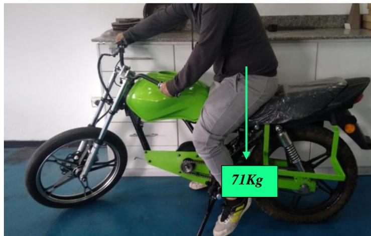
Figura 70. Prueba con 71kg.
