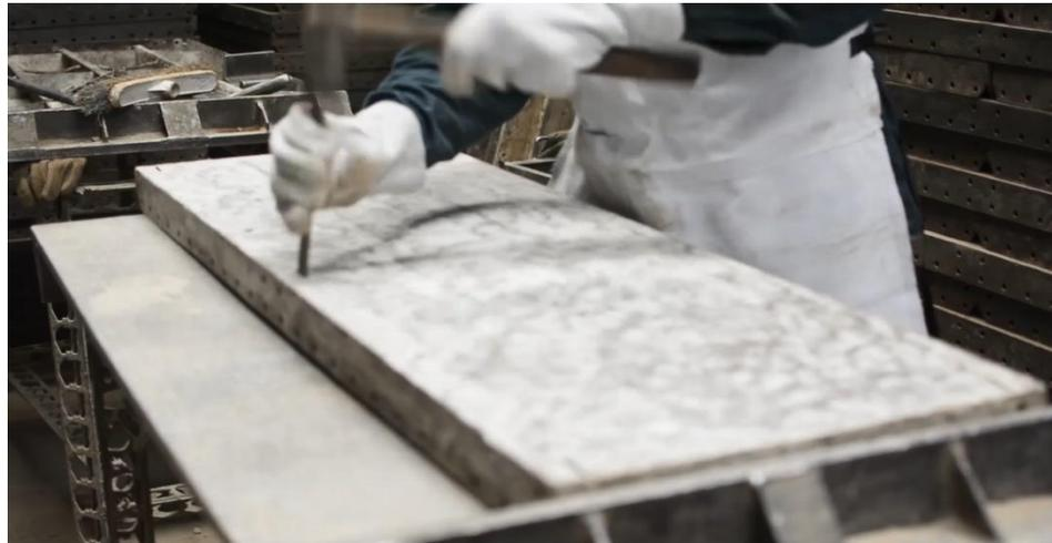
FOTO 33 Imagen Video Metalex. Limpieza de orificios de separadores con cincel corbatero.
