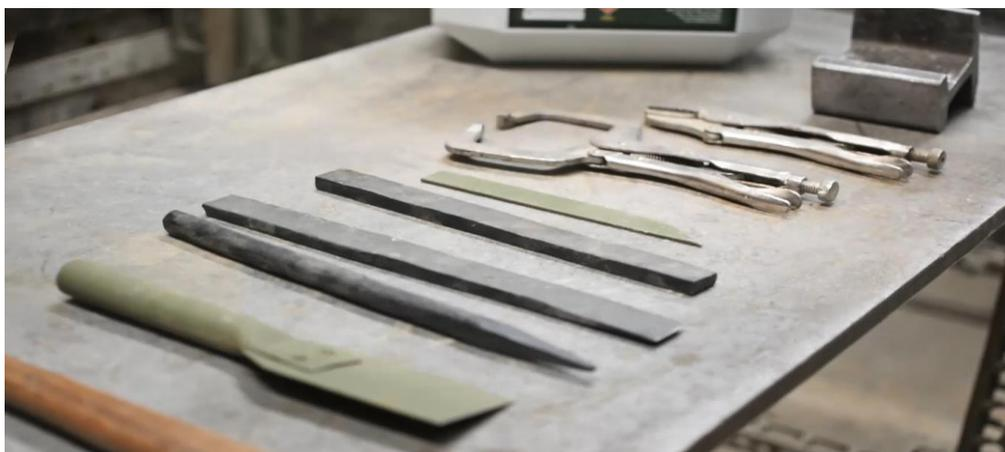
FOTO 24 Imagen Video Metalex. Herramientas para el mantenimiento de formaletas.
