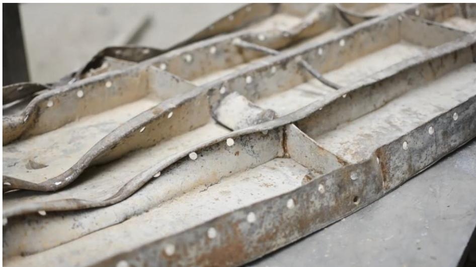
FOTO 47 Imagen Video Metalex. Formaleta deformada su estructura de forma total.
