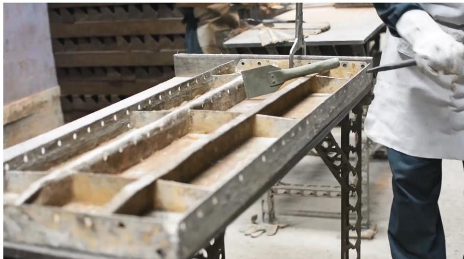
FOTO 35 Imagen Video Metalex. Limpieza de orificios de bandas laterales con cincel de punta.
