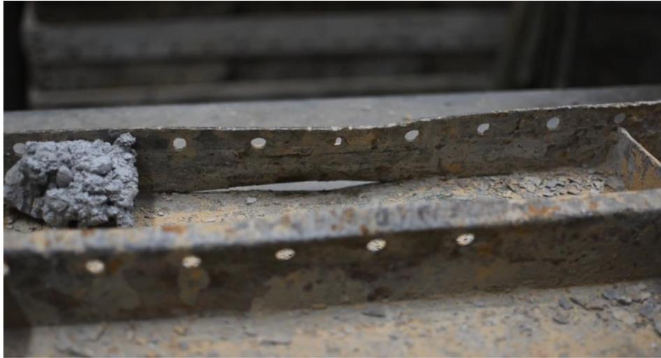
FOTO 46 Imagen Video Metalex. Formaleta con fisuras, perforaciones, abolladuras.
