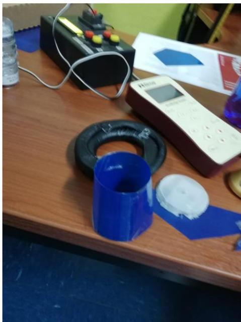
Figura 30. Elaboración de un conducto auditivo para centralizar el ruido que sale del auricular al dosímetro.
