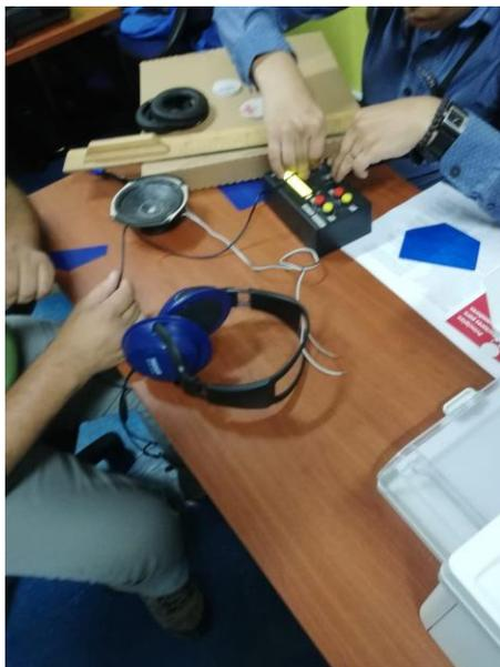
Figura 29. Adaptación de los auriculares al mando de un parlante.
