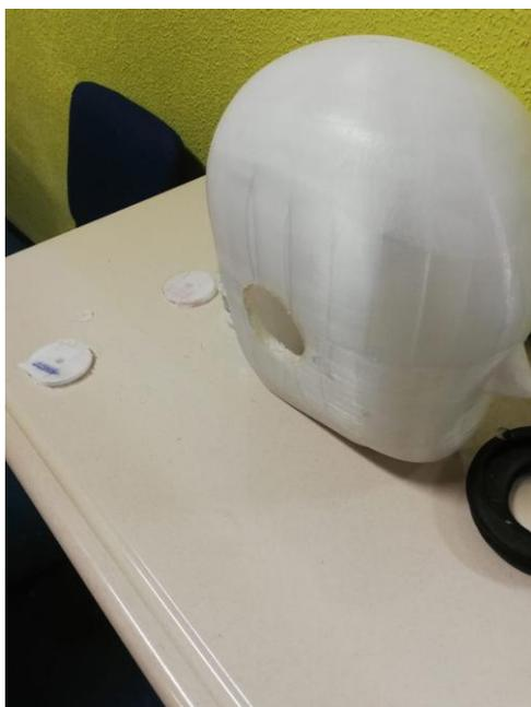
Figura 26. Cabeza del maniquí con abertura del conducto auditivo con un sacabocado.
