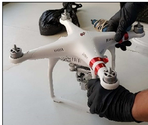
Figura 34. Extracción de las 4 hélices de los rotores. Fuente: autor.
