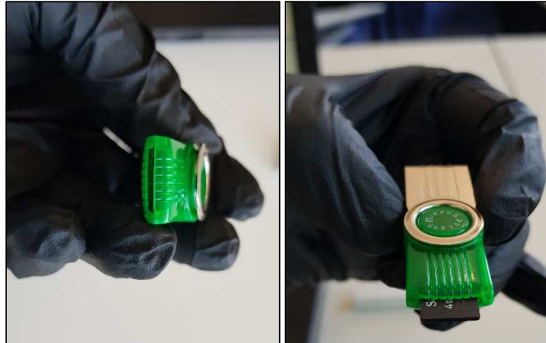
Figura 44. Acoplamiento de la Micro SD con Card Reader USB 2.0.
