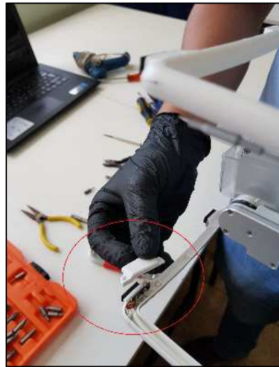
Figura 35. Extracción de la antena del giroscopio, quitar los tornillos de la protección de esta antena.
