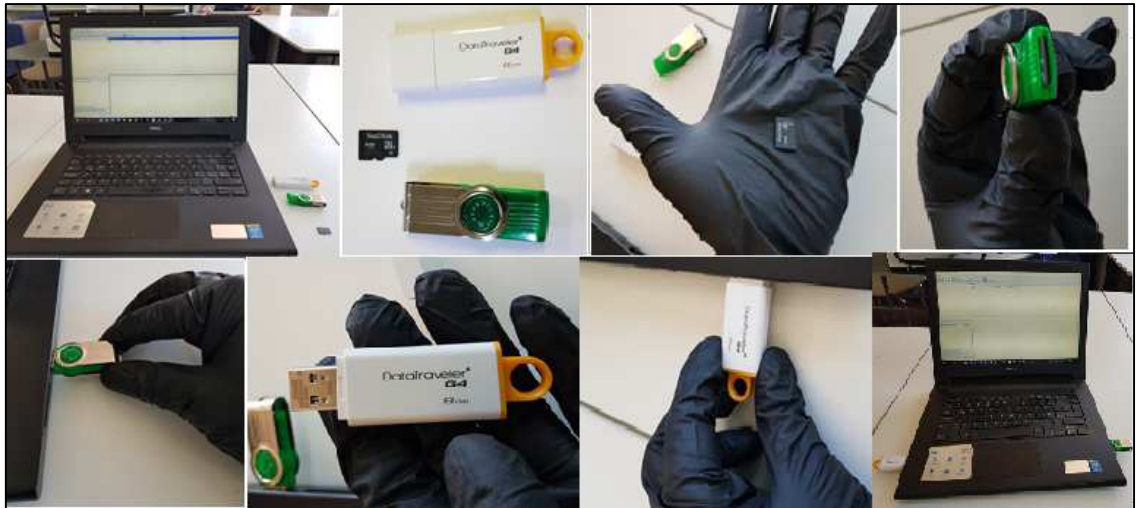
Figura 45. Preparación de los dispositivos para la extracción de la imagen forense de la memoria interna del dron.
