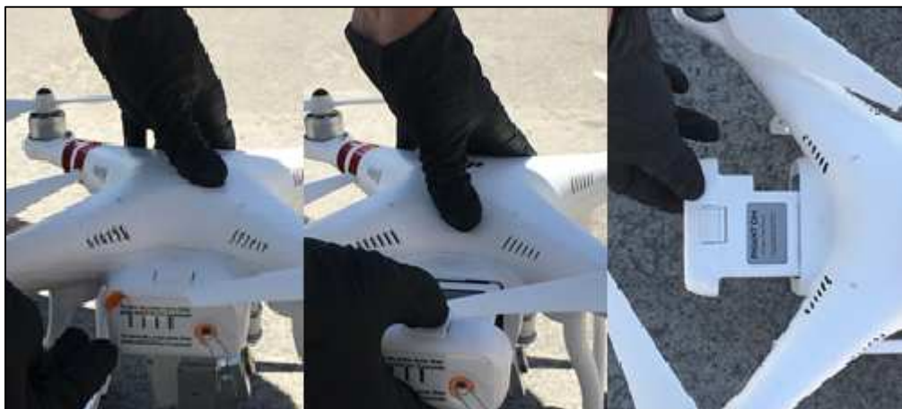
Figura 10. Desmontaje de la batería del dron luego de ser capturado. Fuente: autor.
