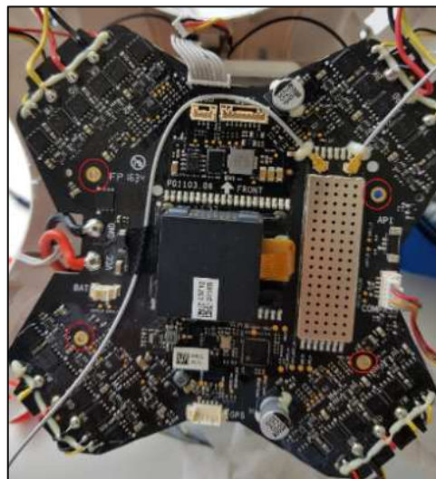
Figura 40. Proceso para desalojar la placa mainboard.
