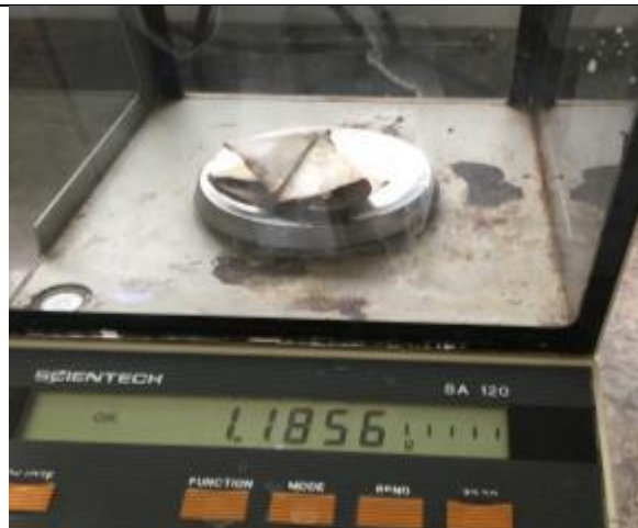
Foto 2: Pesado de papel filtro con sólidos suspendidos.
