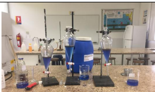
ANEXO B 7. Proceso de decantación para determinar tensoactivos
