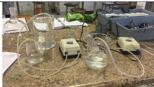
ANEXO B 6. Proceso de aireación para determinar DBO
