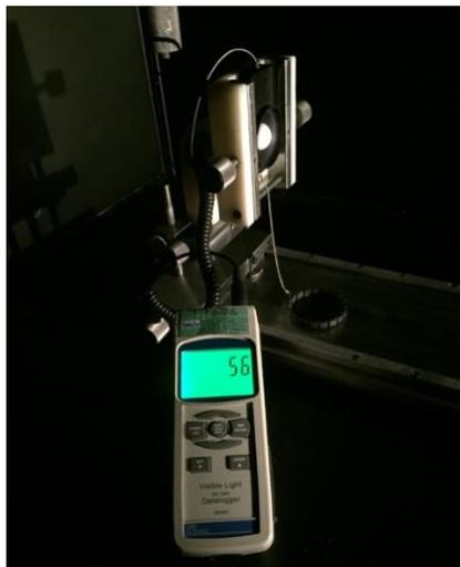
Figura 11. Torre para el fotosensor
