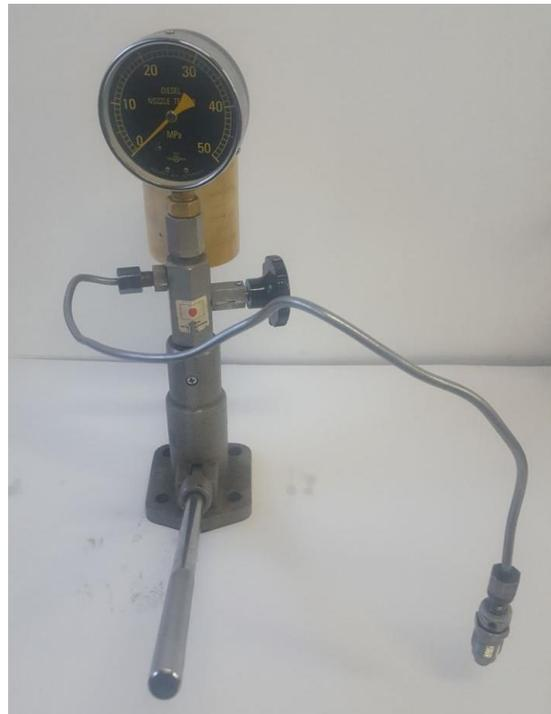
**Figura 7.** Comprobador de inyectores modelo H17.8
