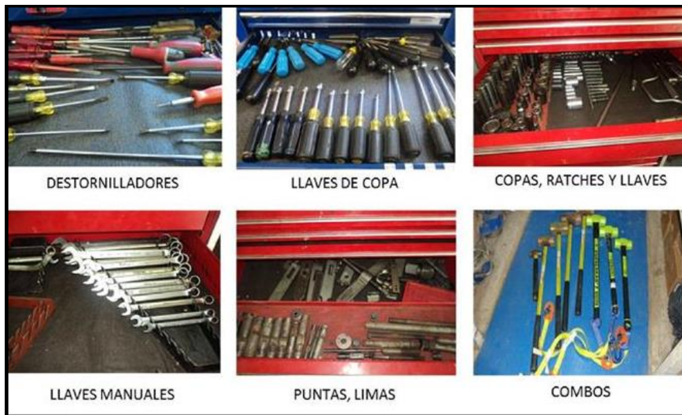
Ilustración 24: Herramientas utilizadas en trabajos para taladros de perforación
