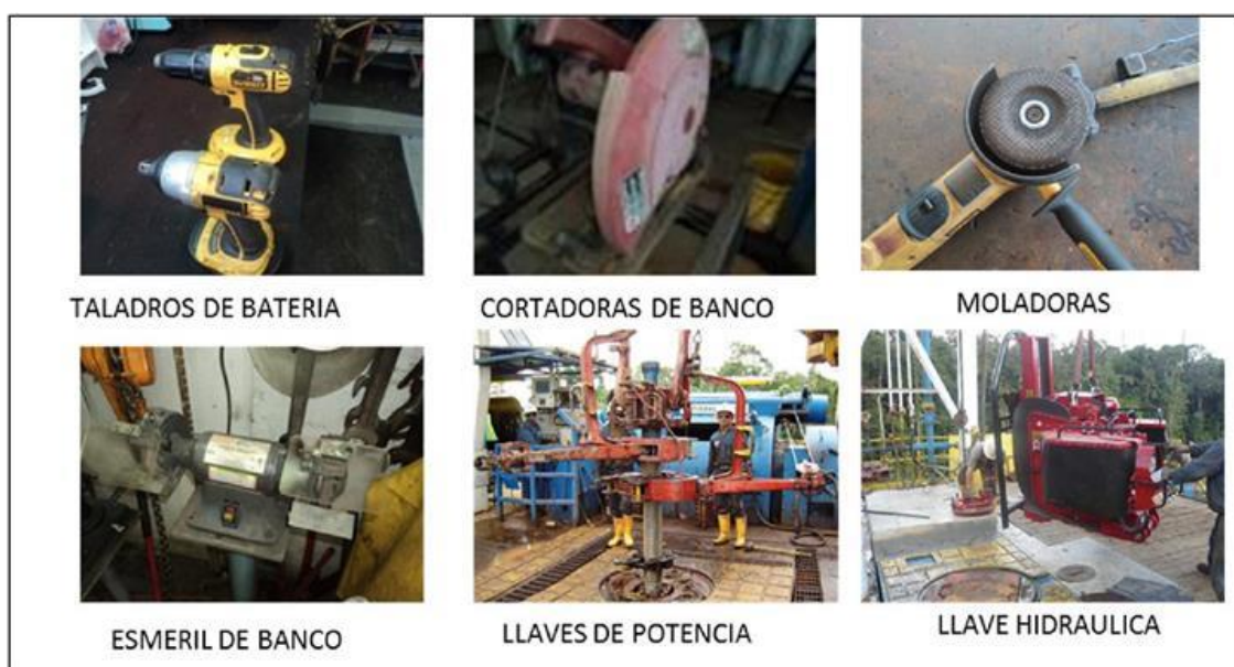
Ilustración 25: Máquinas utilizadas en trabajos para taladros de perforación
