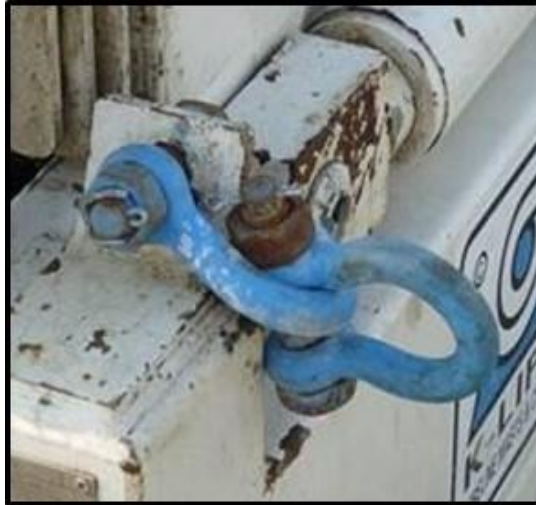
Ilustración 13: Gancho sin mantenimiento
