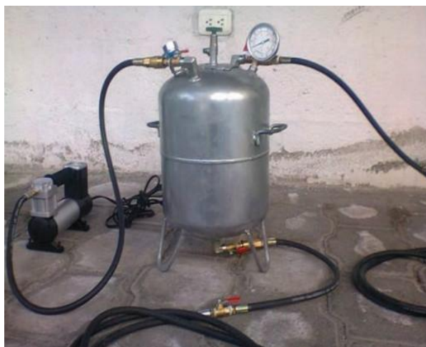
Figura 16. Tanque de presión de combustible
