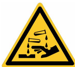
Figura 3.4 Advertencia. Sustancia corrosiva.
