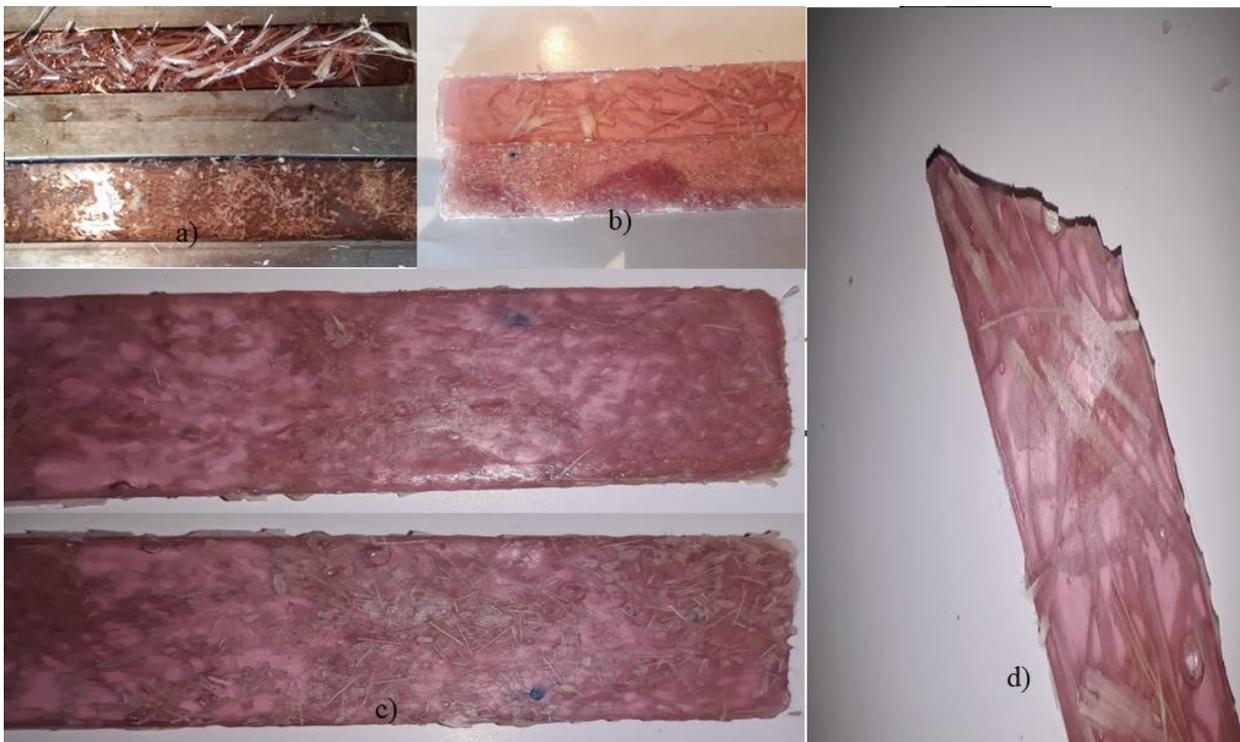
**Figura 31.** Probetas de fibra triturada
