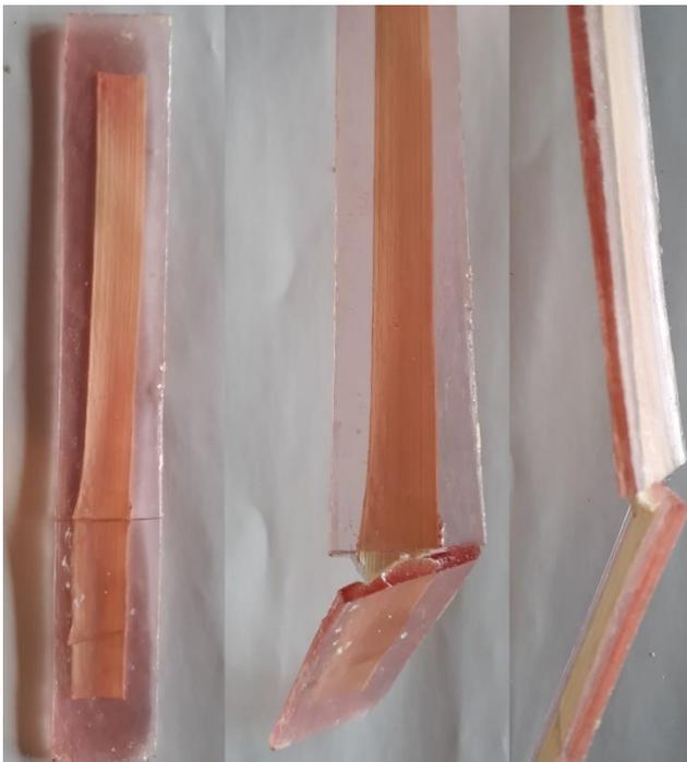
*Figura 26.* Rotura probeta Fv 15%
