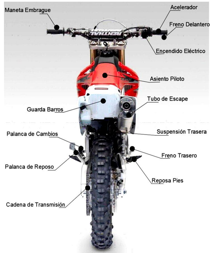
Figura 2. Partes principales de Motocicleta, vistas a) lateral, b) posterior
