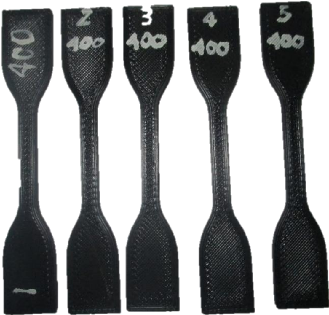
Figura 34. Probetas con 400 horas de exposición a radiación ultravioleta.
