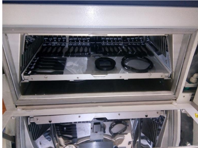
Figura 24. Probetas expuestas en la cámara de Xenón.
