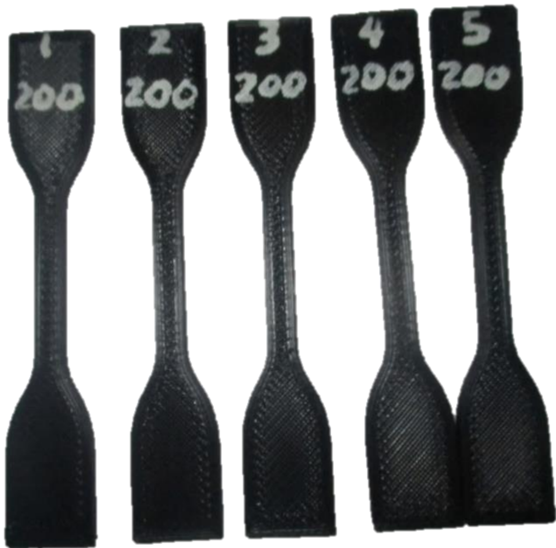
Figura 32. Probetas con 200 horas de exposición a radiación ultravioleta.
