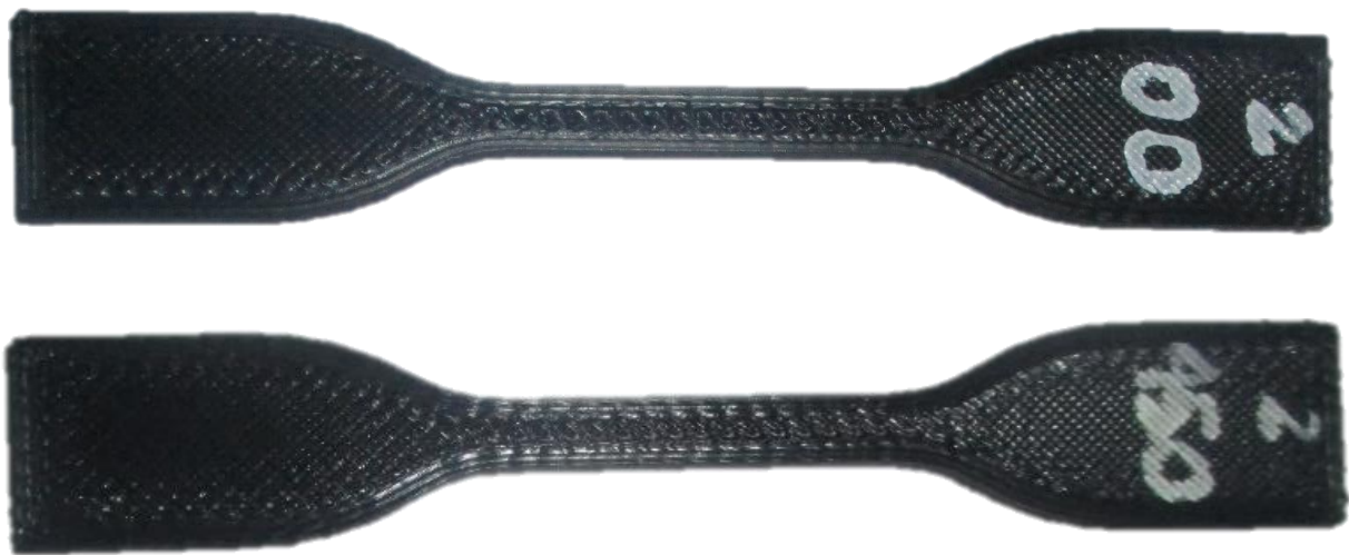
Figura 44. Comparación de la apariencia visual a 0 y 450 horas de exposición a radiación ultravioleta
