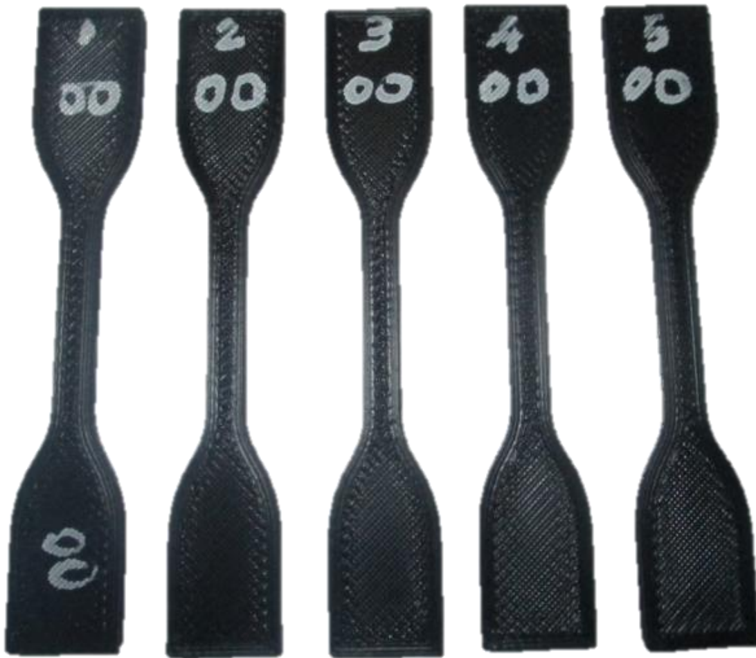
Figura 30. Probetas con 0 horas de exposición a radiación ultravioleta.
