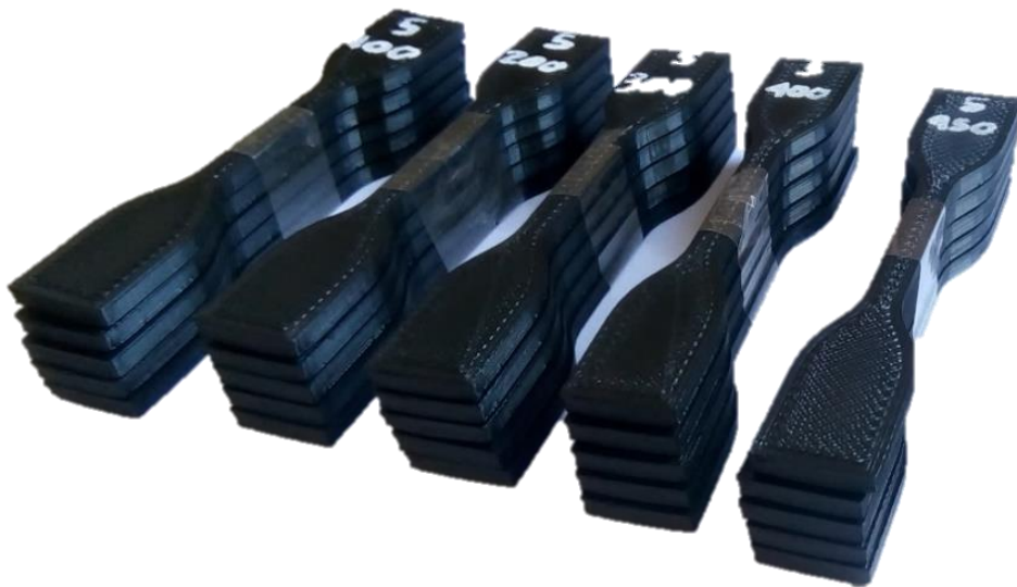
Figura 29. Probetas impresas en 3D para el envejecido artificial.
