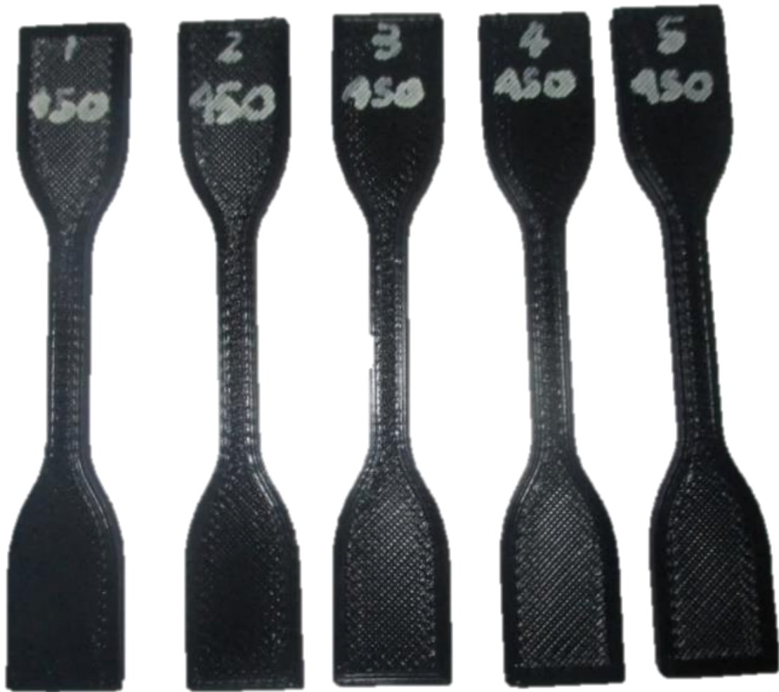
Figura 35. Probetas con 450 horas de exposición a radiación ultravioleta.
