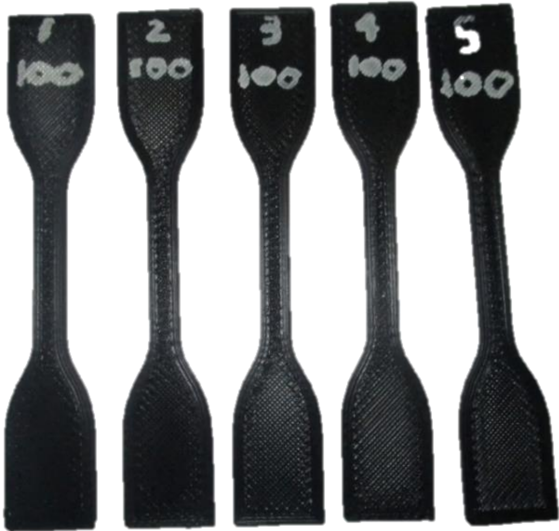
Figura 31. Probetas con 100 horas de exposición a radiación ultravioleta.
