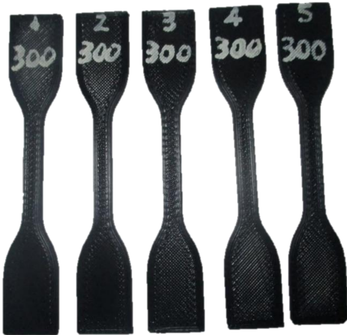
Figura 33. Probetas con 300 horas de exposición a radiación ultravioleta.
