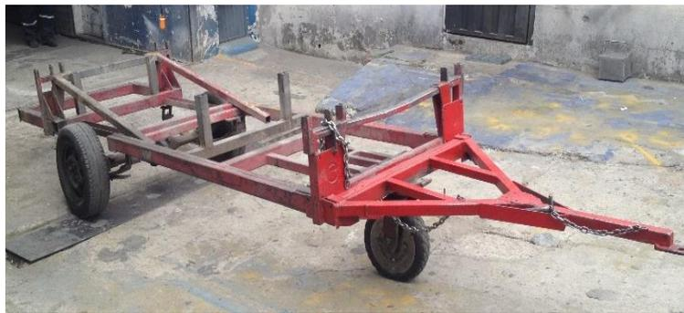
*Figura 19. Remolque para coches tipo skid*
