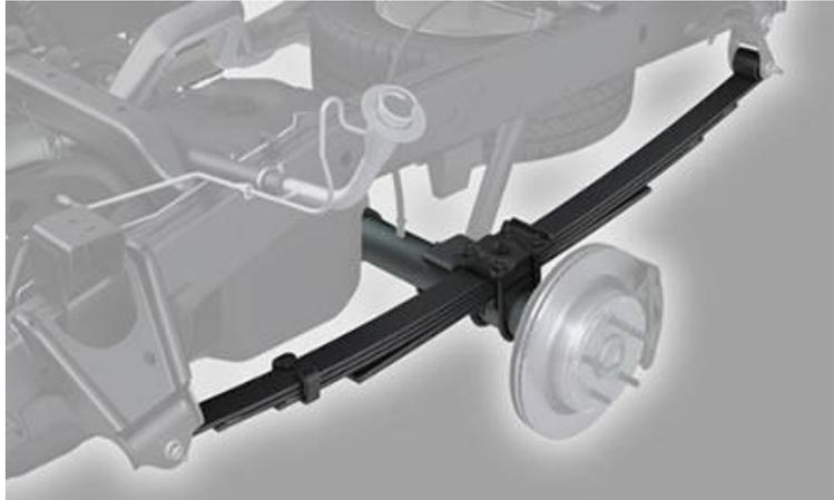
*Figura 6. Suspensión de eje rígido, tomado de (AficionadosalaMecanica, 2016)*
