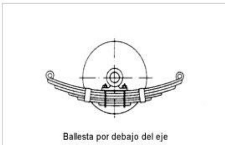
*Figura 9. Ballesta por debajo del eje, tomado de (AficionadosalaMecanica, 2016)*
