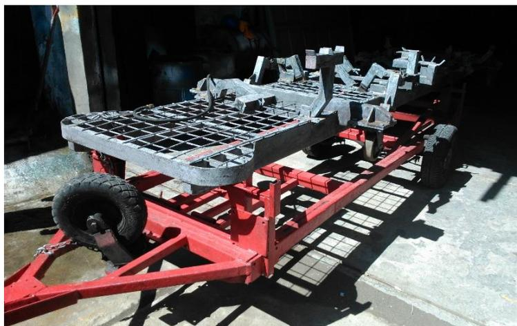
*Figura 20. Remolque para coches tipo skid con carga*
