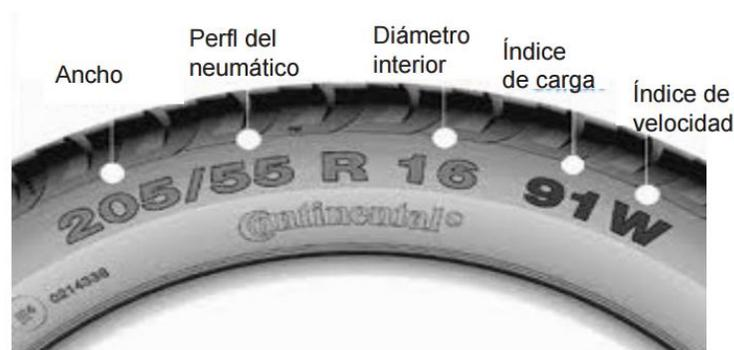
*Figura 13. Medidas de un neumático, tomado de (EditorialMeta, 2016, pp. 4-6)*
