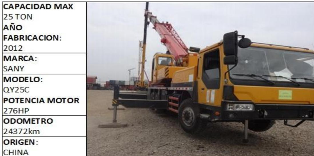
**Figura 3** Grúa móvil Telescópica
