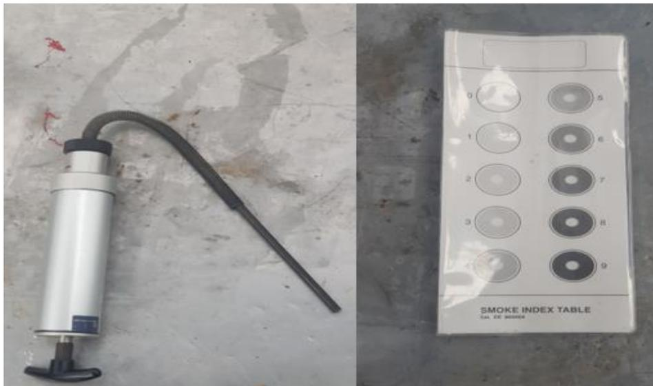
Figura 11. Medidor de Opacidad
