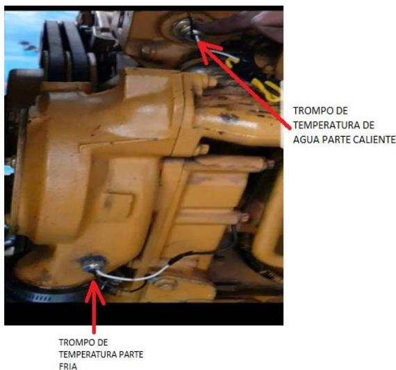
Figura 8. Trompos de Temperatura de Agua.
