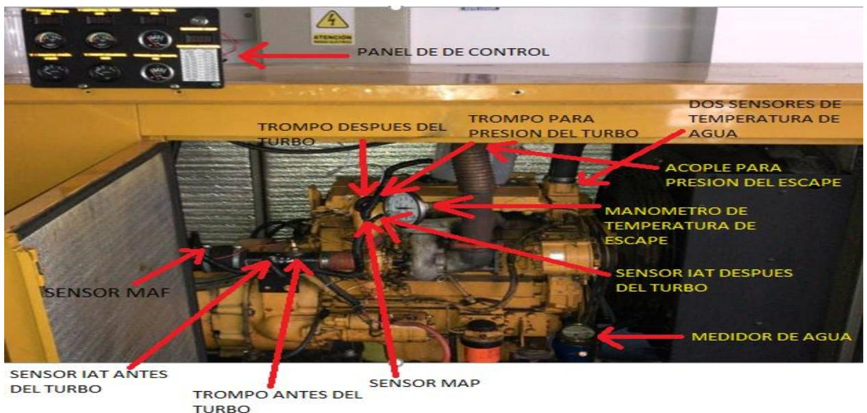
Figura 1. Esquema Básico del Generador Estudiado
