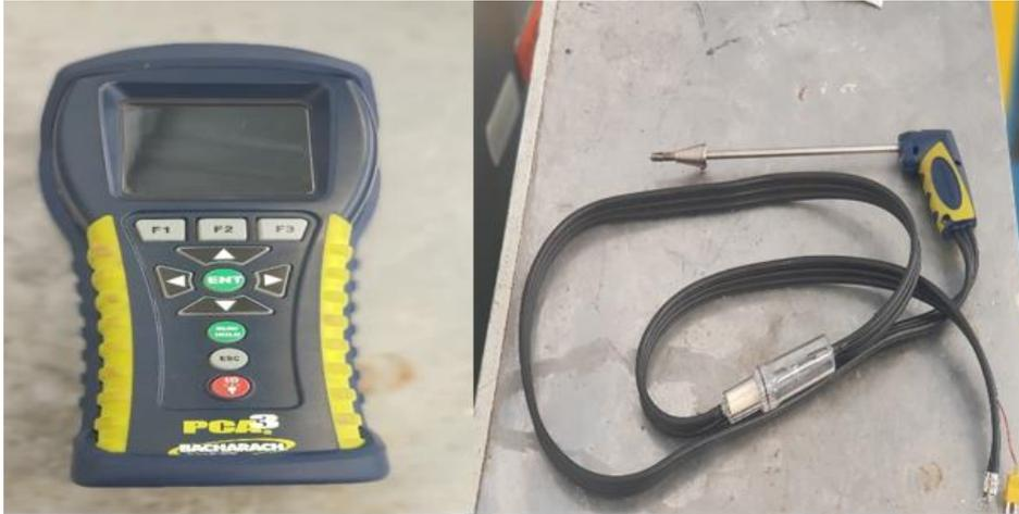
Figura 10. Medidor de Emisiones.
