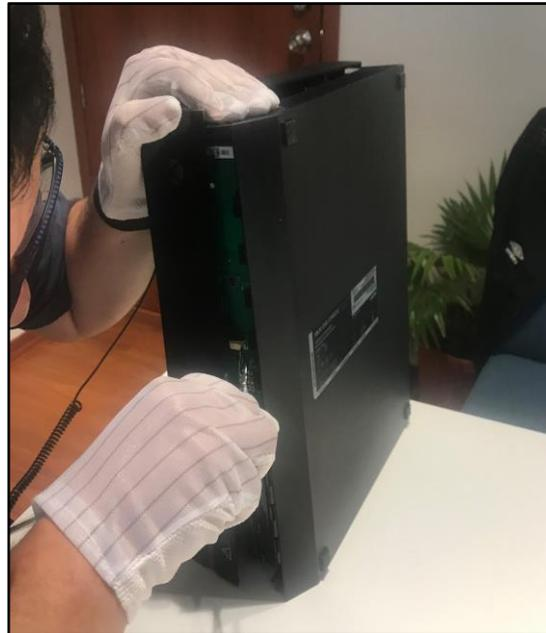
**Figura 27.** Retiro de bus de datos del panel frontal
