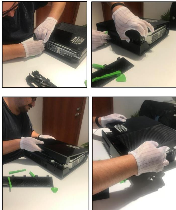
**Figura 25.** Proceso de retiro de cubierta superior
