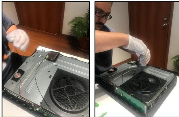
**Figura 31.** Ubicación y desmontaje de tornillos principales de la placa metálica
