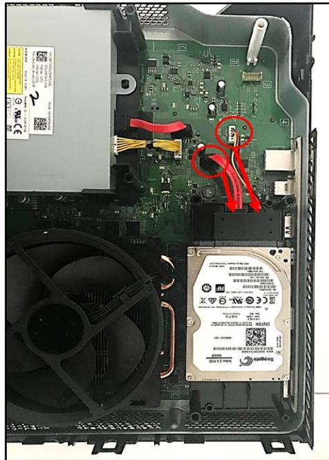
**Figura 33.** Ubicación de los conectores principales del disco duro de la consola
