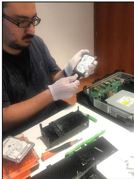
**Figura 35.** Retiro de módulo de conexión disco duro de la consola Xbox One
