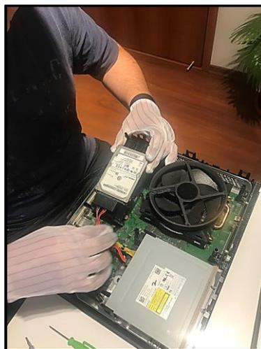
**Figura 48.** Instalación de disco backup en consola Xbox One
