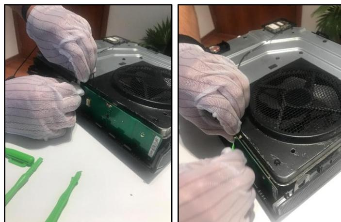
**Figura 29.** Ubicación de los conectores del parlante y el conector de la tarjeta WiFi
