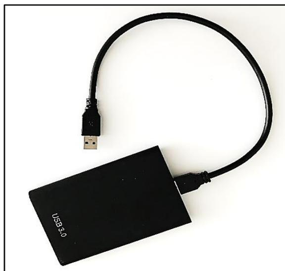
**Figura 36.** Conexión disco duro de consola con enclosure USB
