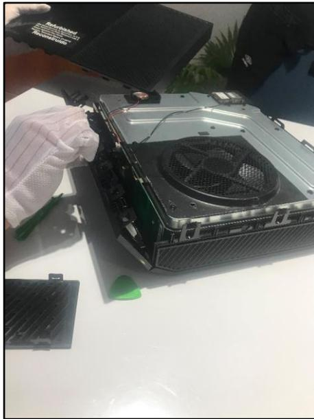
**Figura 26.** Proceso de retiro de panel frontal de la consola
