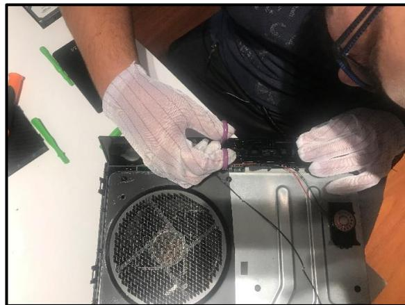
**Figura 49.** Reinstalación del panel frontal y cubierta metálica
