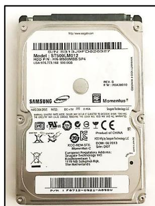
**Figura 16.** Disco duro de 500gb marca Samsung
