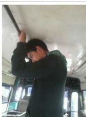
Imagen 3. Altura de techos insuficiente
