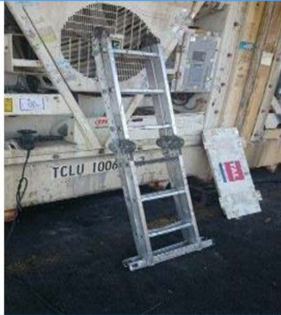
Figura 1. Escalera retráctil empleada para reparación de estructura, actualmente retiradas de la operación y prohibido su uso.
