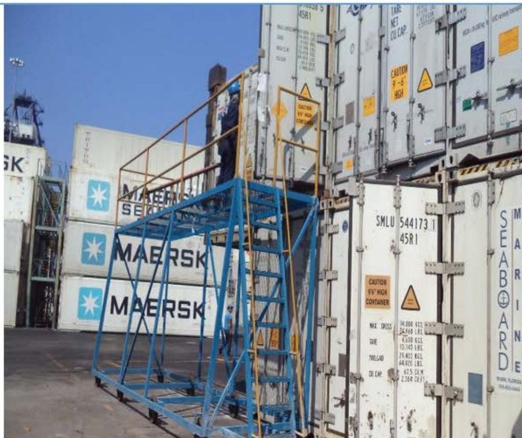
Figura 5. Plataforma para inspección y lavado de contenedores.
