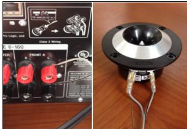
Figura 28. Conexión entre parlante y amplificador. Elaborado por el autor.
