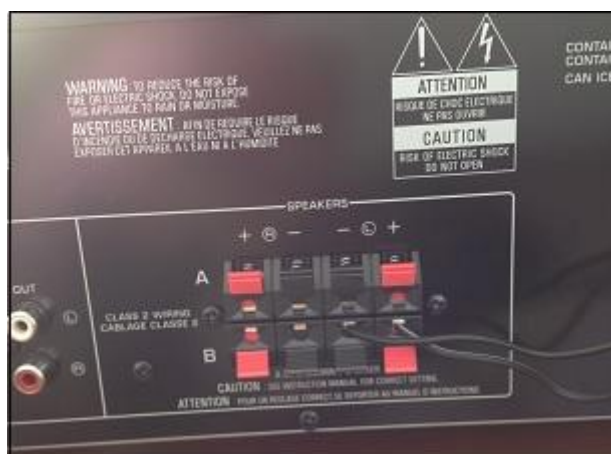
Figura 40. Conexión amplificador Yamaha – parlante. Elaborado por el autor.
