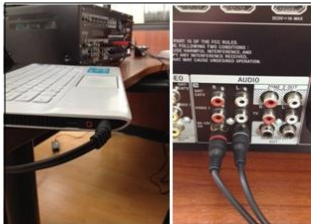
Figura 27. Conexión Sony Vaio con amplificador. Elaborado por el autor.
