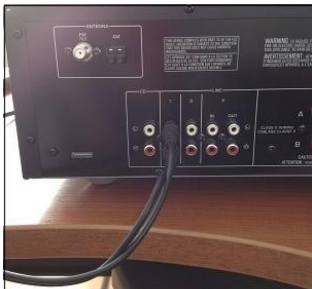
Figura 39. Conexión amplificador – laptop. Elaborado por el autor.
