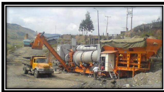
La planta de asfalto utiliza un conjunto de elementos, dispositivos, mecanismos, equipos y sistemas dispuestos de tal manera para producir mezcla asfáltica en caliente, el cual es la capa que se utiliza para cubrir los pavimentos de calles y carreteras de hormigón y está constituida de agregados pétreos mezclados con material bituminoso.
