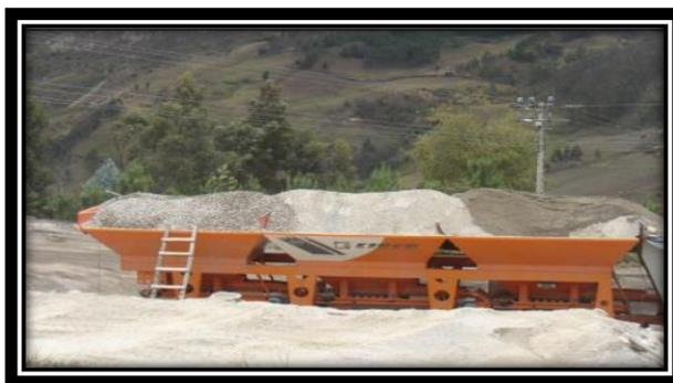
Todo este sistema funciona con energía eléctrica y es operado a través de un cuarto de control, el cual está situado en la planta procesadora de asfalto. Una vez que el material es trasladado al tambor, éste funciona con un caldero, y es en donde se produce el secado a altas temperaturas.
