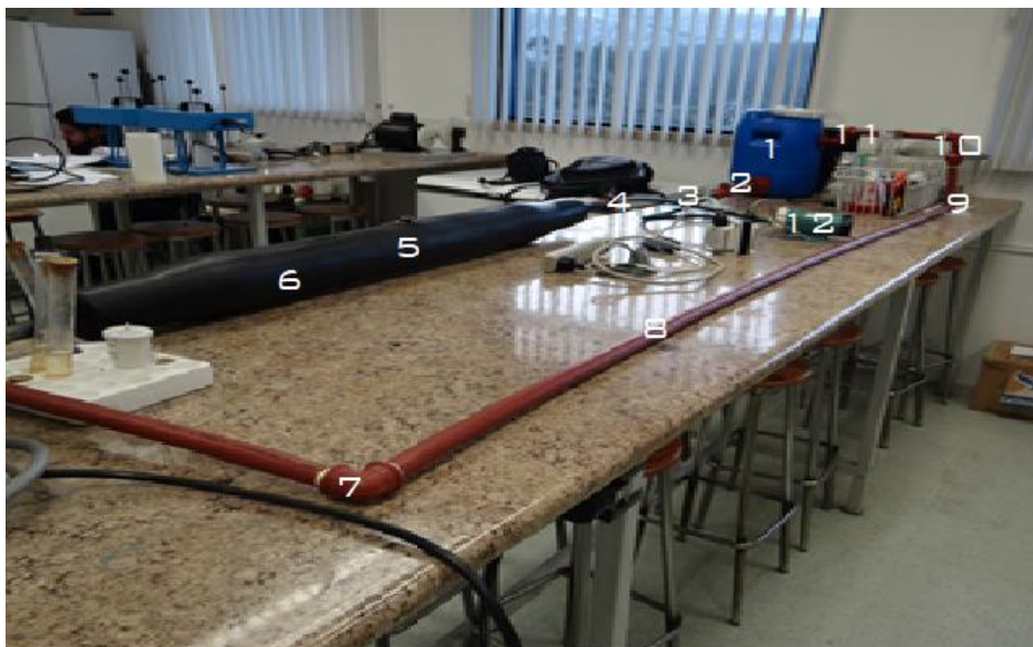
Figura 9 Equipo de obtención de velocidad de corrosión y simulador de condiciones de operación
