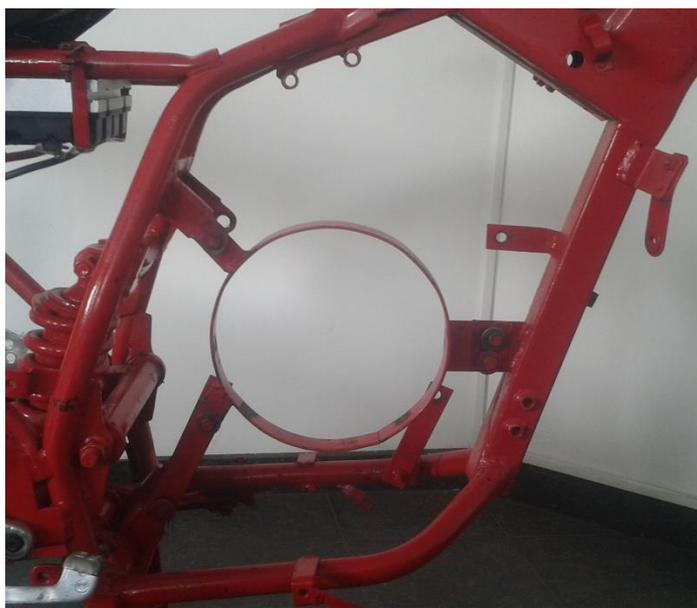
*Figura 80.* Ubicación del soporte posterior del motor eléctrico.
