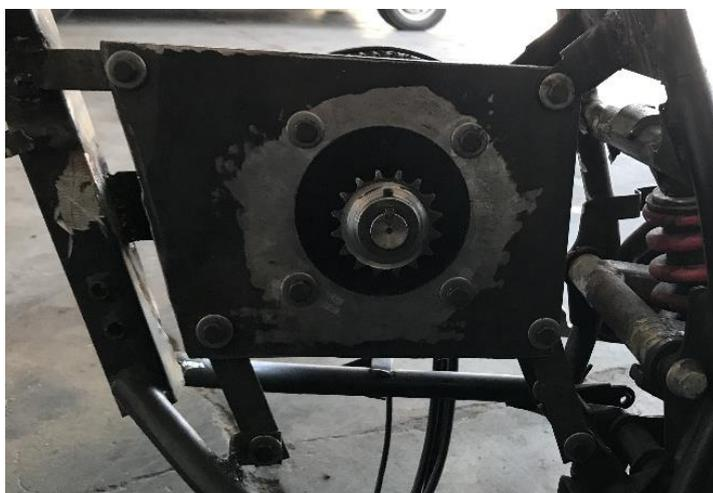
*Figura 68.* Adaptación de la catalina conductora.
