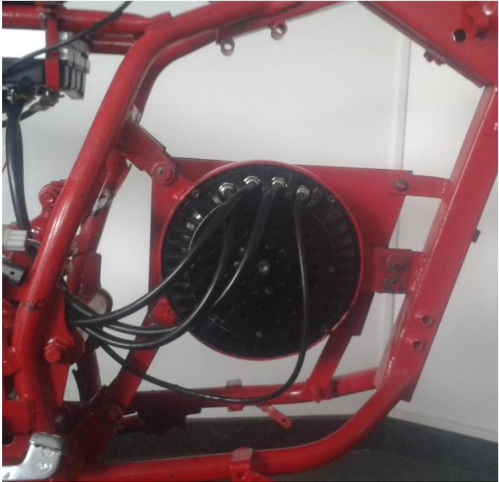
*Figura 82.* Comprobación geométrica del motor eléctrico – Soporte posterior.
