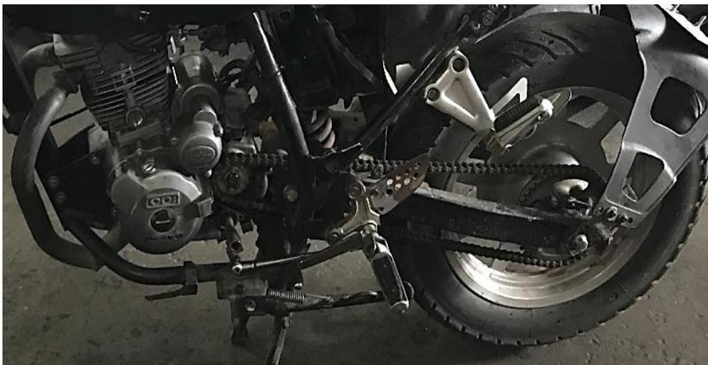
*Figura 37.* Alineación de catalinas entre caja de cambios y rueda posterior.
