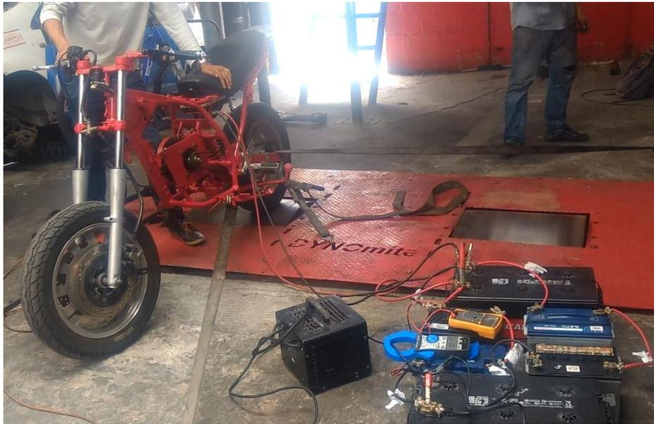
*Figura 90.* Prueba Final de la Motocicleta eléctrica en el dinamómetro.
