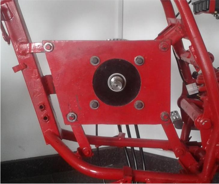
*Figura 81.* Comprobación geométrica del motor eléctrico – Soporte delantero.
