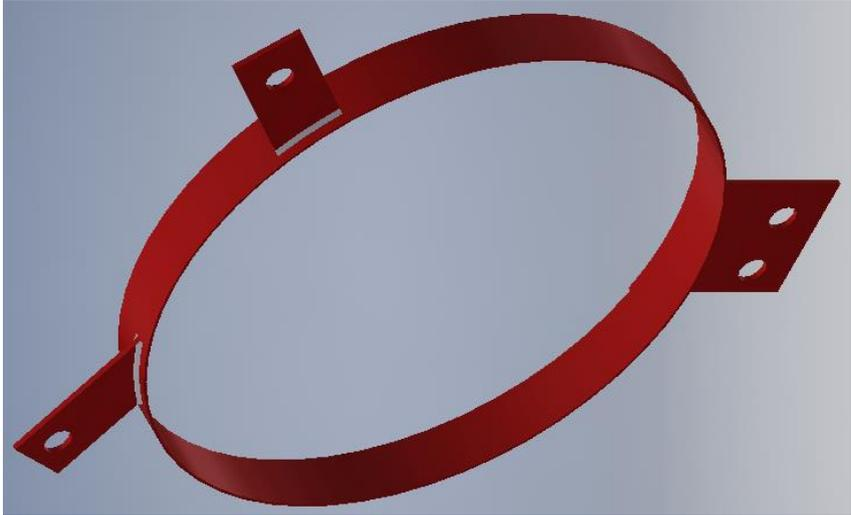
Figura 51. Diseño geométrico soporte posterior del motor – Inventor.
