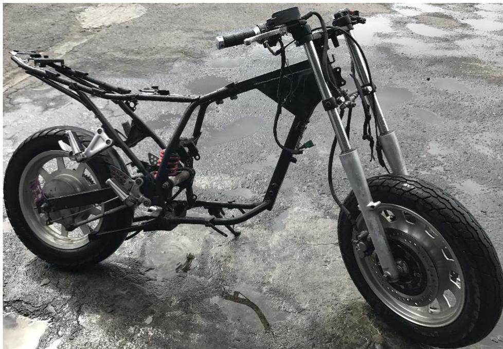
*Figura 61.* Desmontaje total de la motocicleta Tundra.
