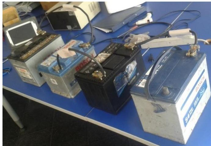
Figura 72. Conexión de cuatro baterías físico.
