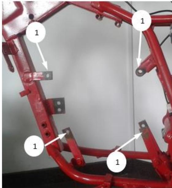
*Figura 48.* Los puntos que marcan 1, muestran las ubicaciones donde va estar acoplado el soporte delantero del motor.
