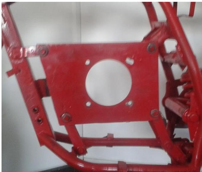
*Figura 79.* Ubicación del soporte delantero del motor eléctrico.
