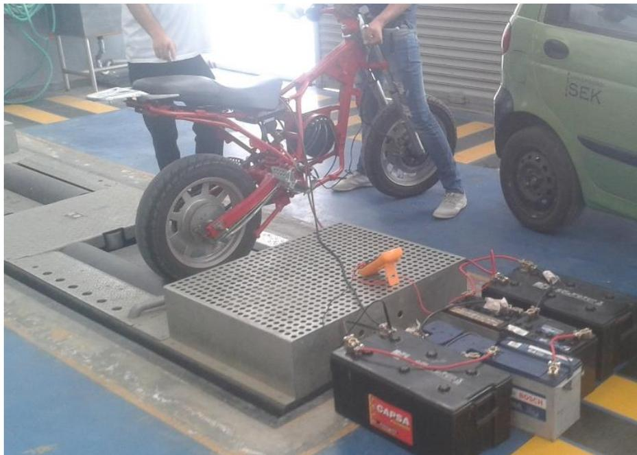
*Figura 89.* Prueba de fuerza en dinamómetro.
