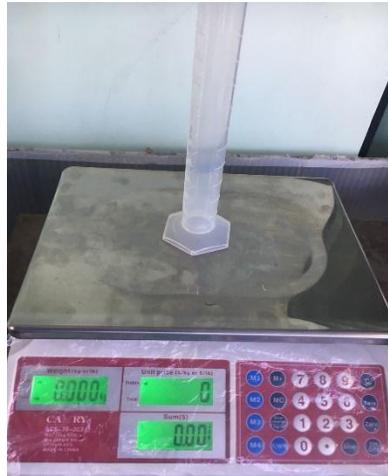
*Figura 11.* Probeta de 100 ml en balanza electrónica
