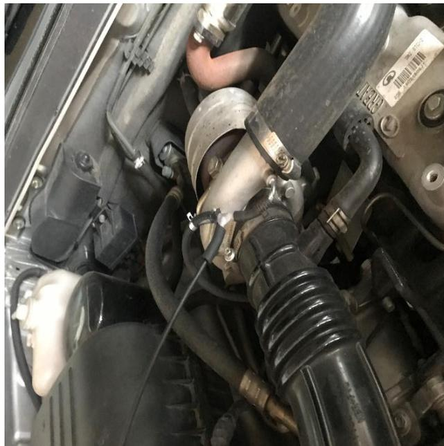
Figura 18. Acople de presión asociado al turbo del vehículo
