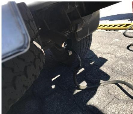
*Figura 27. Sonda lambda conectada al tubo de escape*
