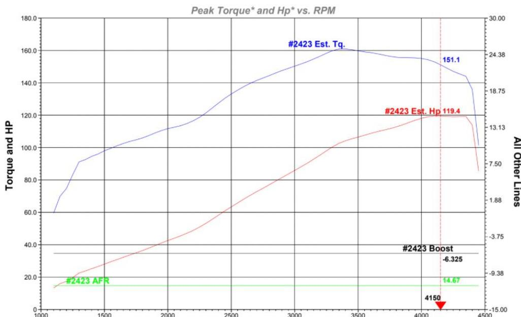
Figura 44. Prueba N°2 de torque y potencia con biodiesel 10% y aditivo
