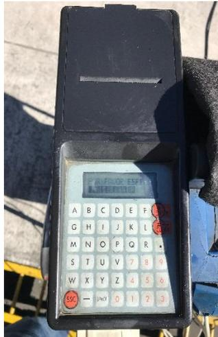
*Figura 26. Terminal de mano del opacímetro*
