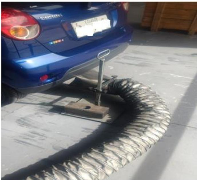
Figura 24. Sonda y ducto de escape para el análisis de gases
