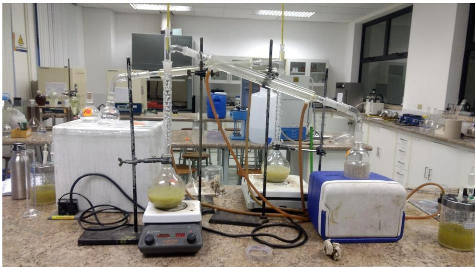
Figura 7. Equipo de destilación simple
