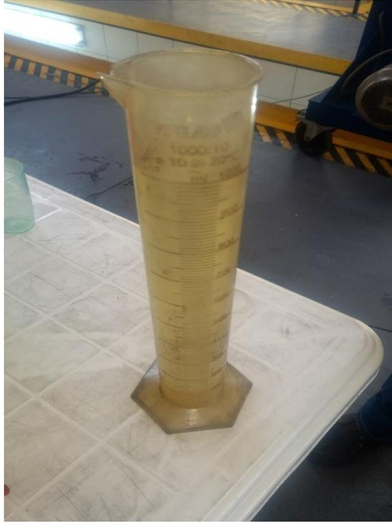
Figura 26. Probeta graduada de 1000 mL
