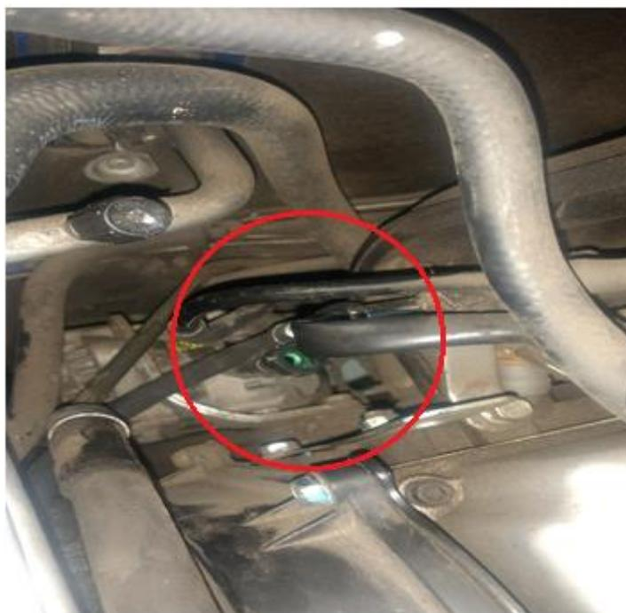
Figura 28. Conexión de tanque de presión en el riel de inyección
