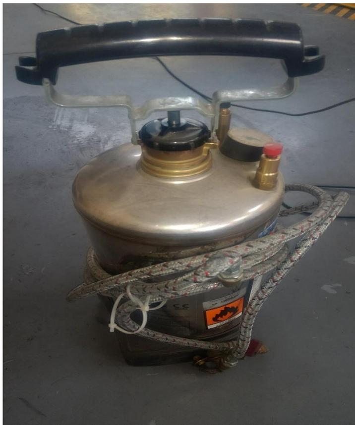
Figura 27. Tanque presión de combustible
