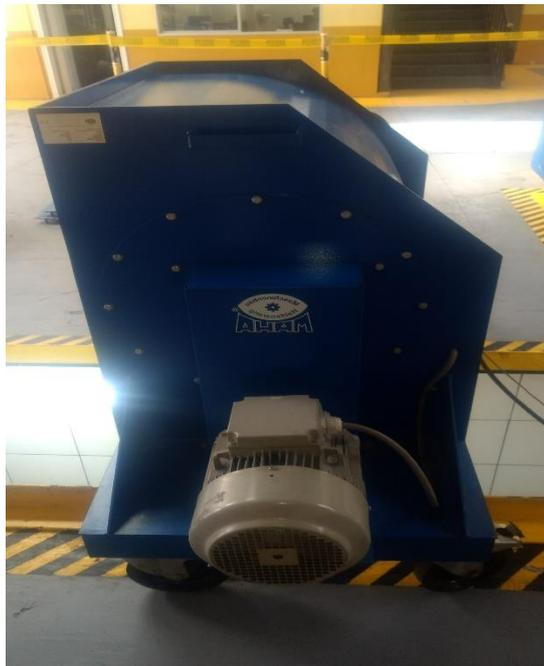
Figura 23. Ventilador de refrigeración
