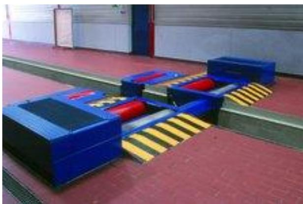
Figura 9. Dinamómetro de rodillos
