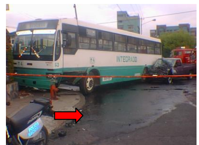
Huellas de líquido refrigerante del radiador.
