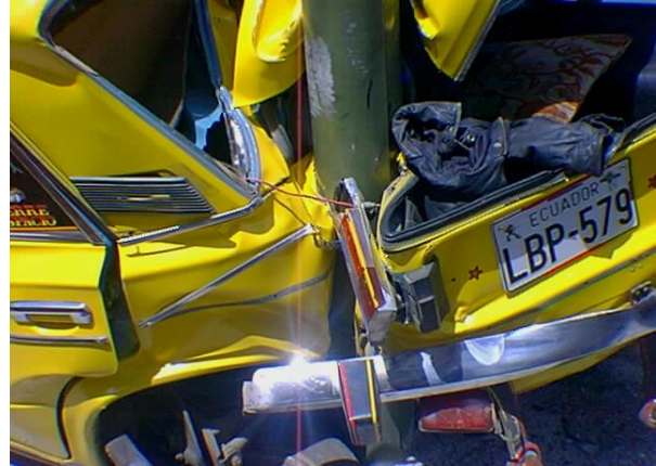
Figura 18. Estrellamiento posterior contra un poste (semáforo).
