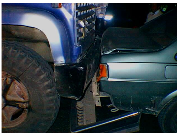
Figura 28. Choque por alcance. Posición final de los vehículos
