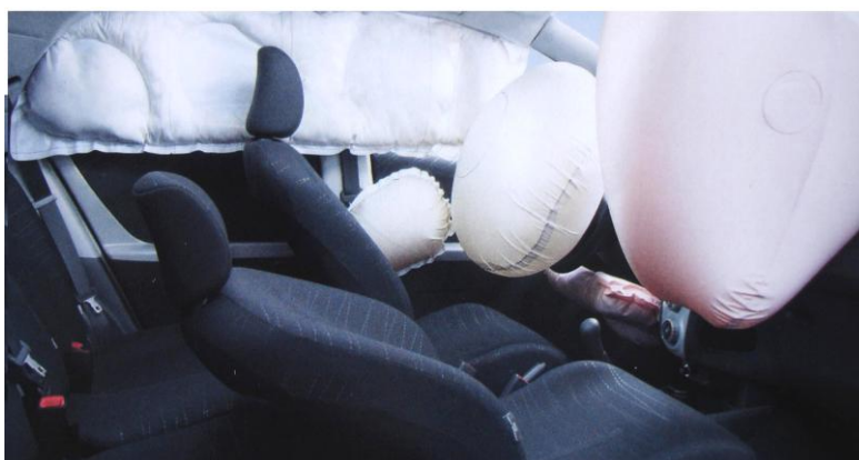
Figura 5. Protección del conductor mediante el sistema airbag dispuesto en el volante, puerta y techo.
