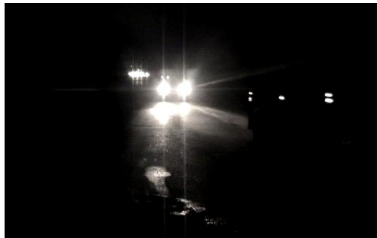
Figura 11. Deslumbramiento provocado por los faros de un vehículo sobre un conductor que circula en sentido contrario.
