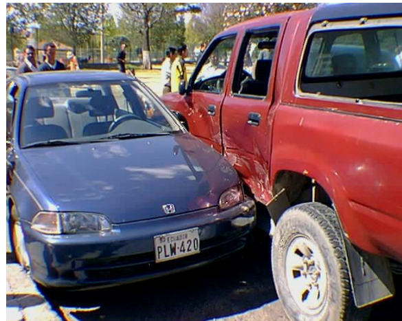
Figura 72. Roce positivo. Daños en pintura y plancha metálica.
