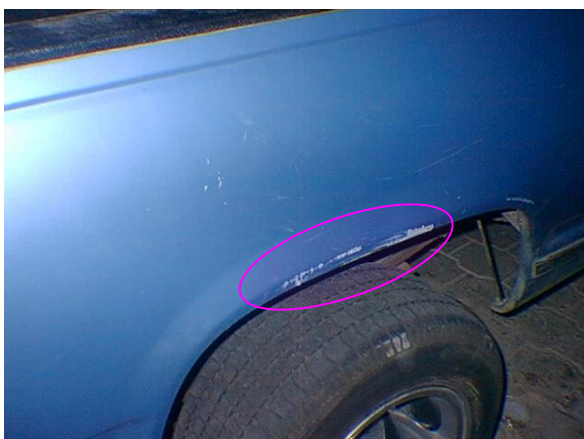
Figura 20. Rozamiento. Afectación de capa de pintura.
