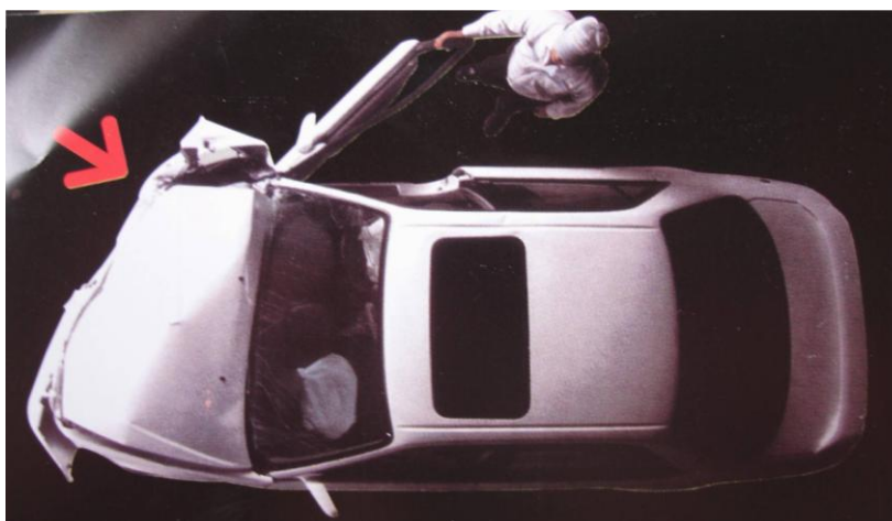
Figura 2. Carrocería GOA luego de un choque frontal. Fácil apertura de la puerta.
