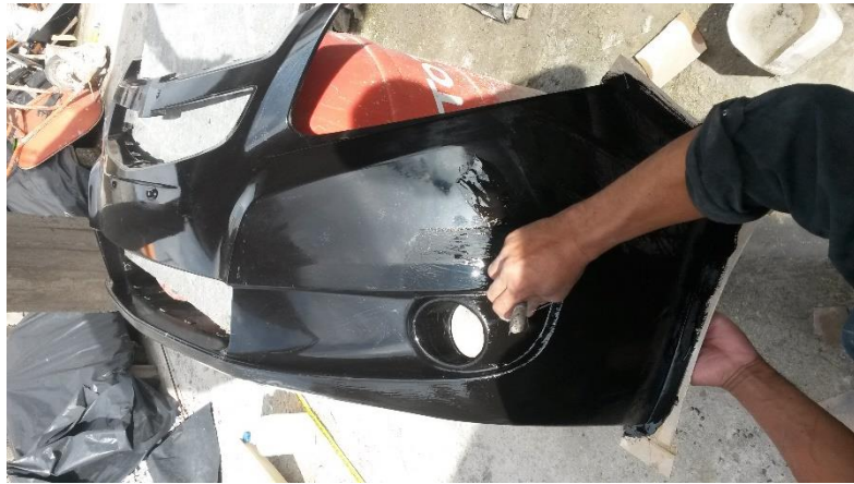
Figura 20. Aplicación del gelcoat mediante brocha
