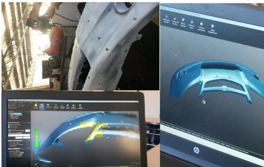
Figura 24. Obtención de la topografía del guardachoque mediante escáner 3D
