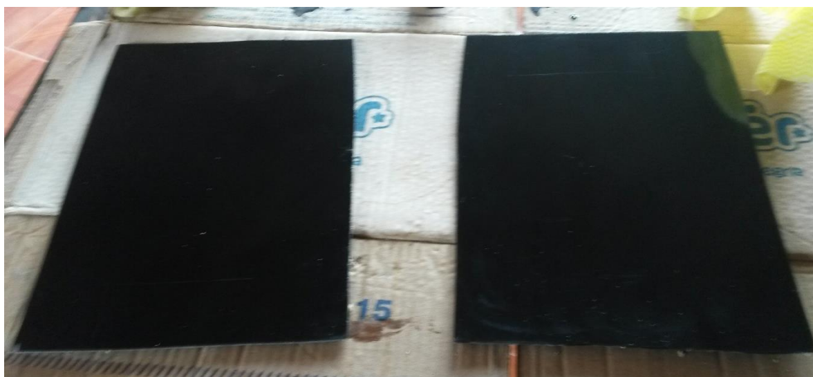
Figura 38. Muestras de resina reforzada con fibra de vidrio utilizadas para simular el molde
