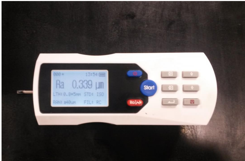
Figura 41. Ajuste de parámetros y medición mediante el rugosímetro
