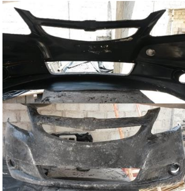
Figura 22. Vista frontal y posterior del molde resina reforzado por fibra de vidrio
