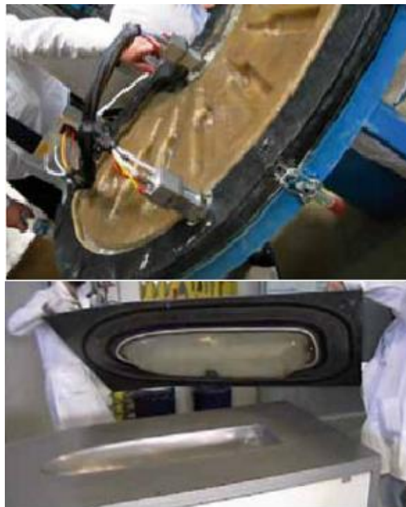
Figura 7. Proceso y molde VARTM (OWENS CORNING [OCV], 2009)
