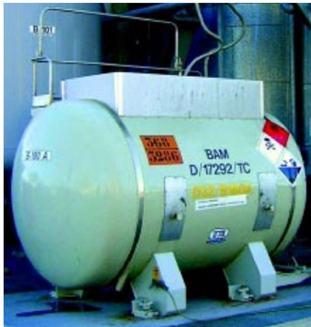
**Figura 07.5.** Cisterna móvil con panel y etiquetas de identificación de sustancia peligrosa según ADR
