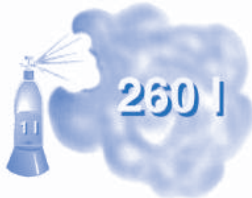
Figura 2.4: Una cantidad incluso pequeña de líquido inflamable ya puede, al evaporarse, provocar grandes cantidades de vapores inflamables (ejemplo: propano licuado).
