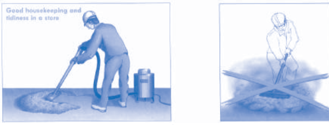
Figura 3.2: Eliminación de depósitos de polvo 9
