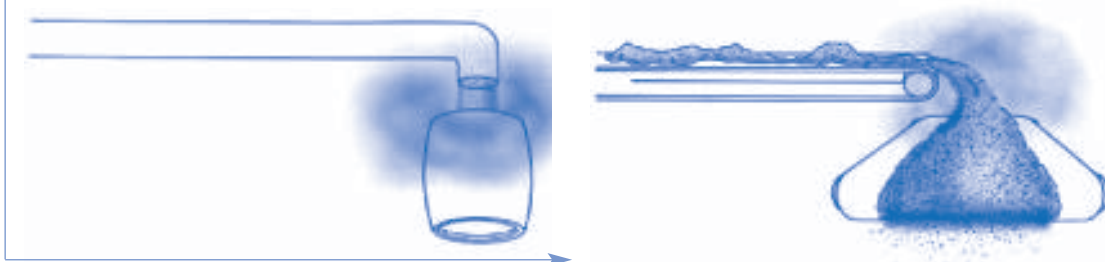
Figura 2.2: Ejemplos de formación de mezclas polvo/aire en procesos de llenado y transporte 5 .
