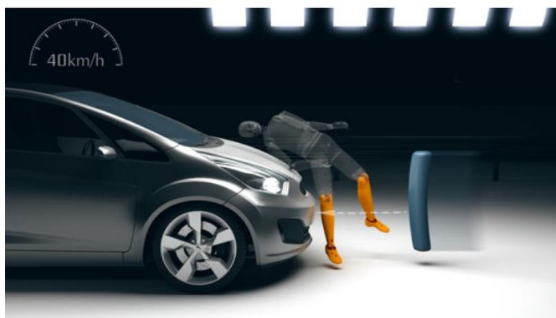
Figura 8. Ensayo físico entre un impactador de miembros inferiores y un vehículo. (EuroNCAP, 2017)
