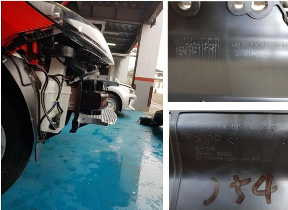
Figura 12. Vista lateral del refuerzo superior e inferior del guardachoque y material dado por el fabricante.
