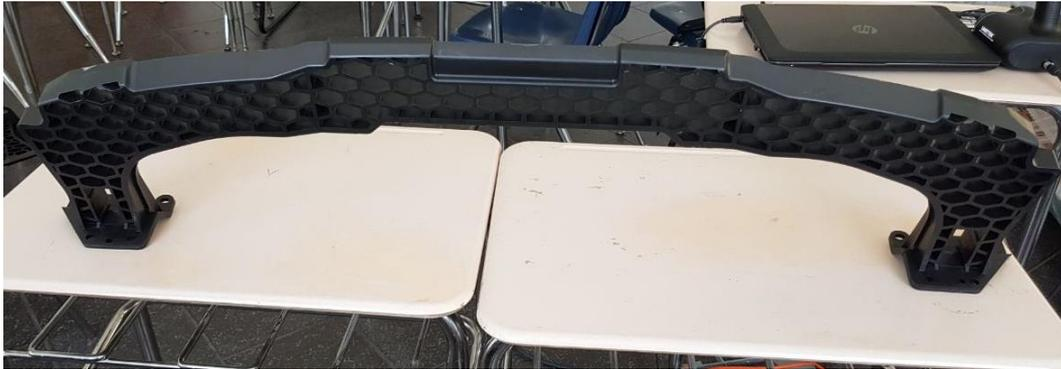
*Figura 17.* Refuerzo superior de guardachoque.
