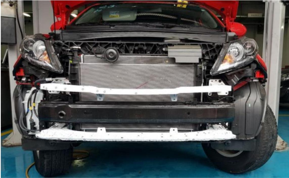
*Figura 11.* Refuerzo inferior y superior de guardachoques de un Sportage R.
