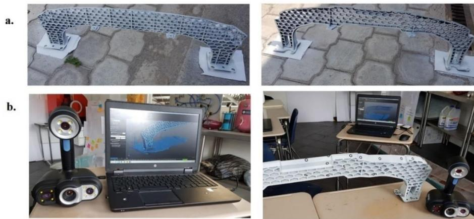
Figura 19. a) Refuerzos de guardachoques pintados de color blanco. b) Scanner 3D GO/SCAN50.
