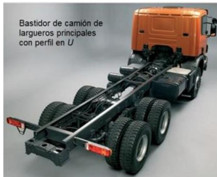
*Figura.2.* Bastidor de camión de largueros principal con perfil “U”
