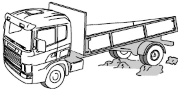
*Figura 9:* Factores que producen las cargas dinámicas en el vehículo
