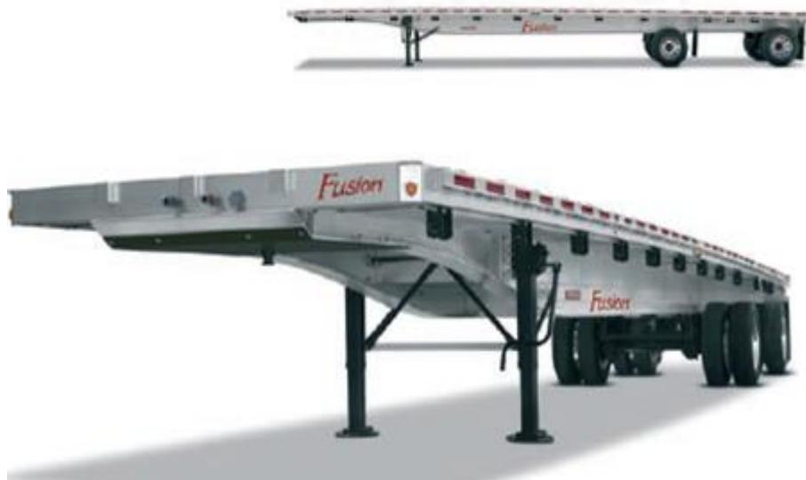
*Figura 4:* Plataforma con bastidor de perfil T
