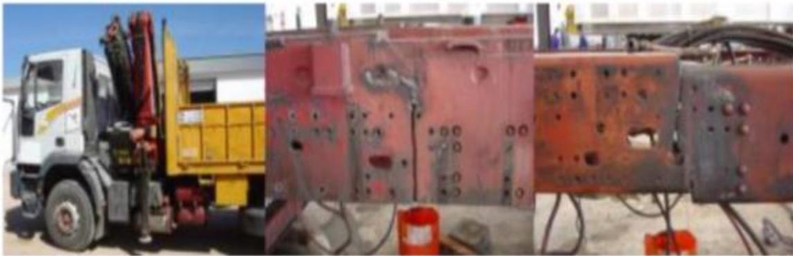
*Figura.6:* Fallo a rotura en bastidor de camión con grúa auto portante.
