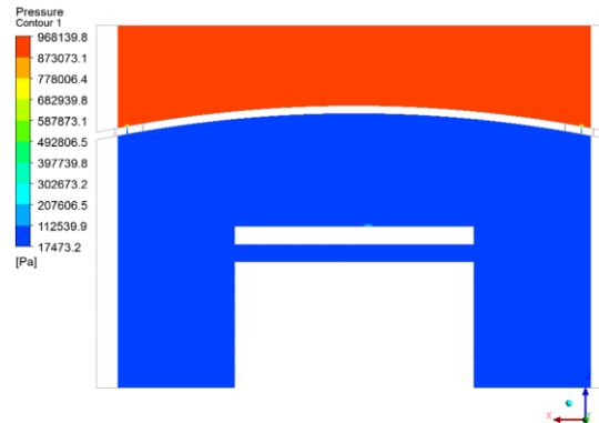
Figura 42. Presión máxima – Persiana 2 a 60km/h. Fuente: ANSYS
