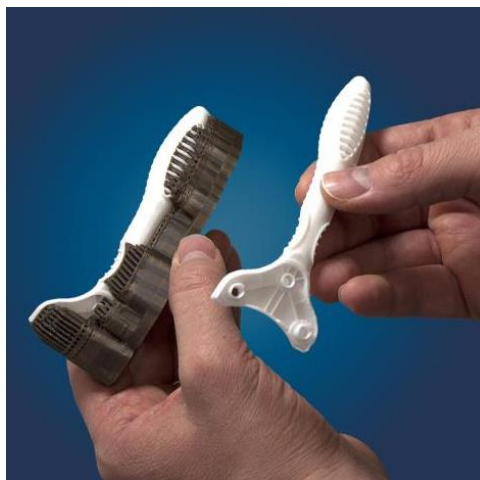
Figura 21. Material soporte (color blanco, café). Fuente: Strataysys, (2016)
