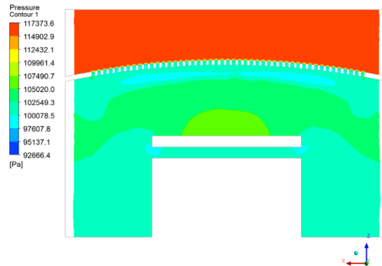
Figura 33. Presión máxima - Persiana 1 a 90km/h. Recuperado de ANSYS
