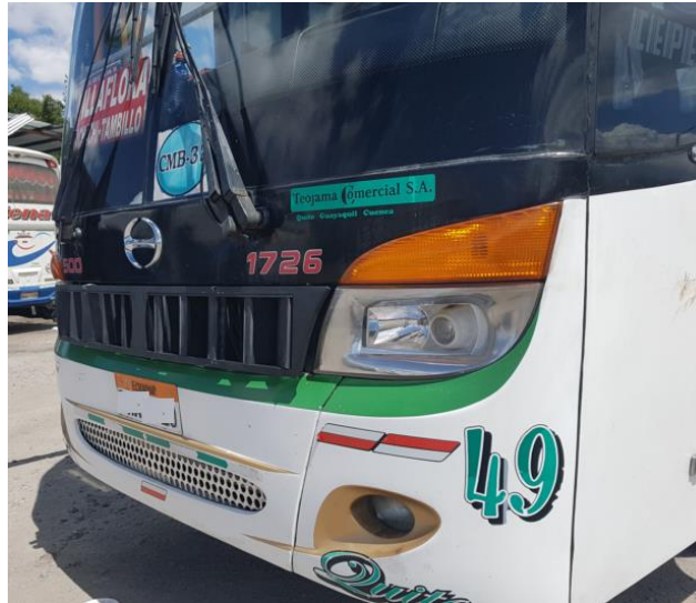
Figura 81. Persiana 3 con apertura de aspas a 90° instalada en el autobús. Fuente: Propia
