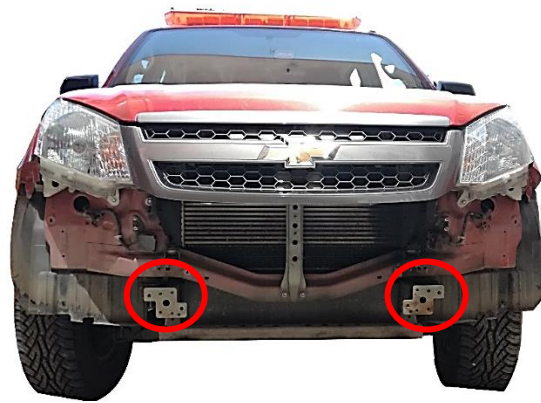
Figura 53. Puntos de anclaje en la camioneta DMax RT50
