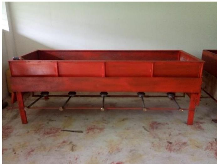
*Figura 11.* Horno secador de Macadamia empresa Negoingo, (Negoingo Sa, 2015)
