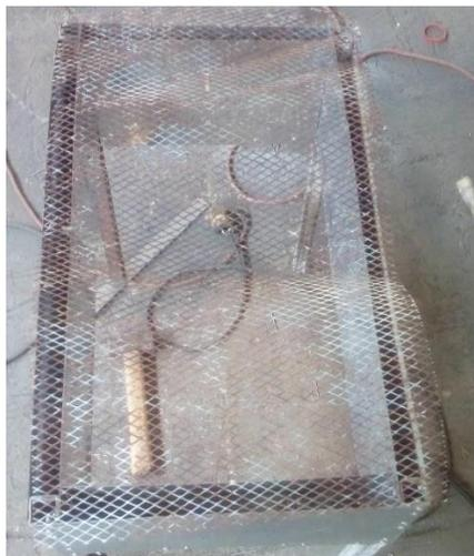
*Figura 17.* Malla expandida para el horno prototipo. (ArceloMittal, 2016)
