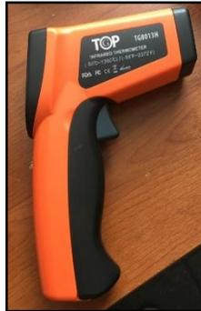
*Figura 20.* Pistola de Temperatura Marca TOPG modelo TG8013H, (Delgado, 2017)
