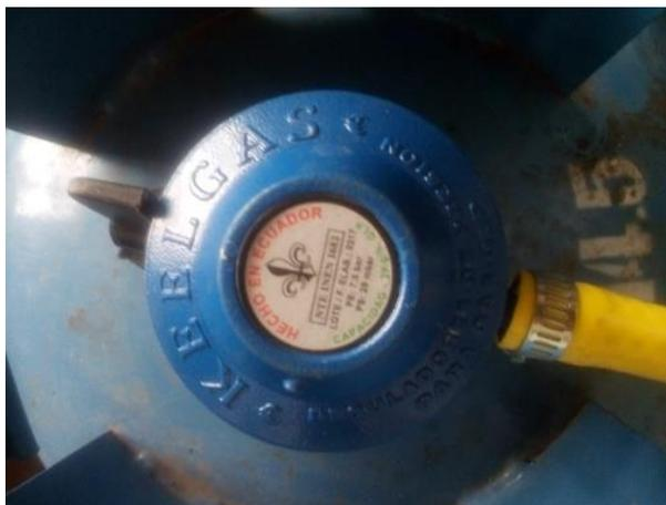
Figura 14. Válvula Reguladora de GLP para el horno prototipo, (Keelgas cia.Ltda, 2015)
