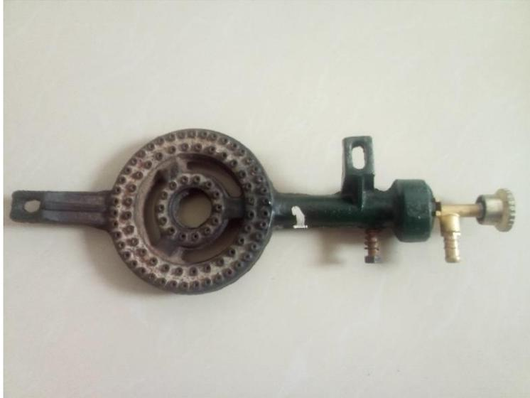
*Figura 13.* Quemador atmosférico para horno prototipo, (Gasolec, 2017)
