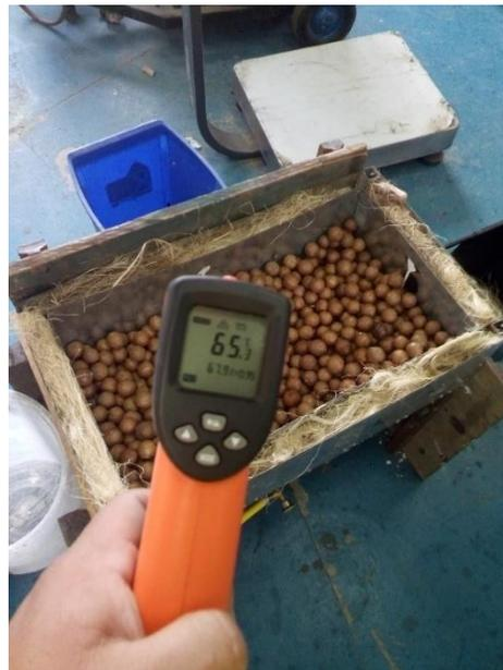
*Figura 31.* Macadamia seca a temperatura optima, 100% de aislante en el horno
