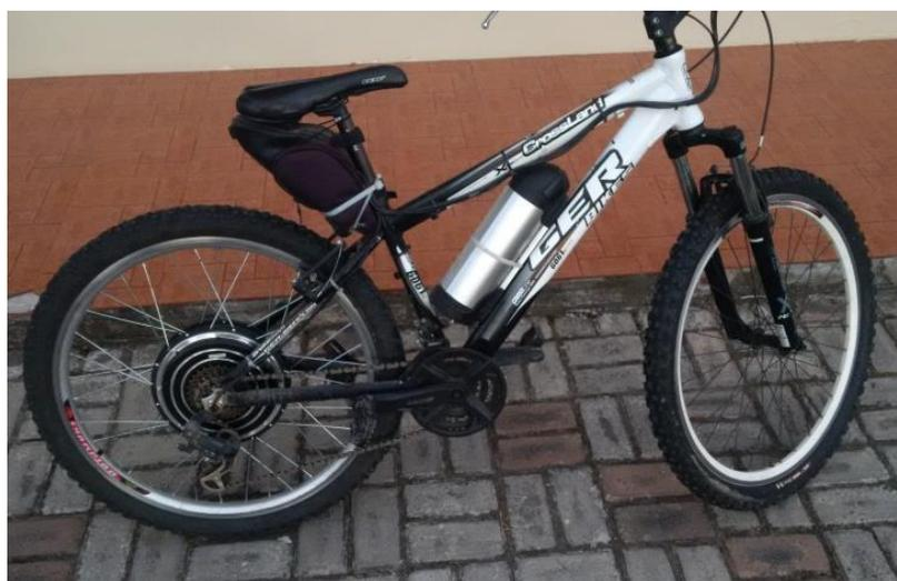
*Figura 17. Modelo convencional bicicleta eléctrica.*
