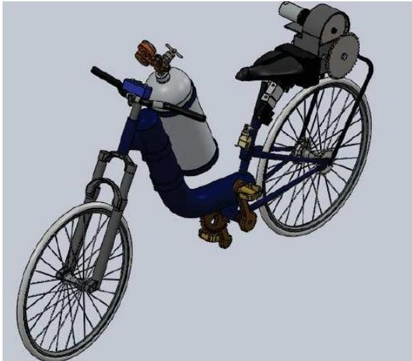
*Figura 8.* Modelo prototipo bicicleta impulsión neumática
