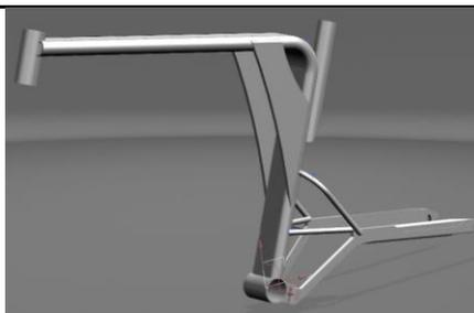
**Deformación máxima** 0.48 mm.
