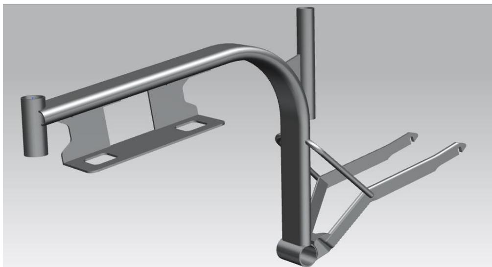
*Figura 57. Modela 3D con modificación en prototipo 2*
