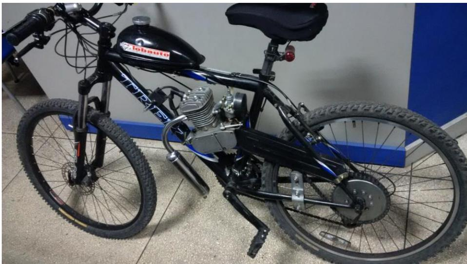
*Figura 5.* Bicicleta impulsada con motor de combustión interna.
