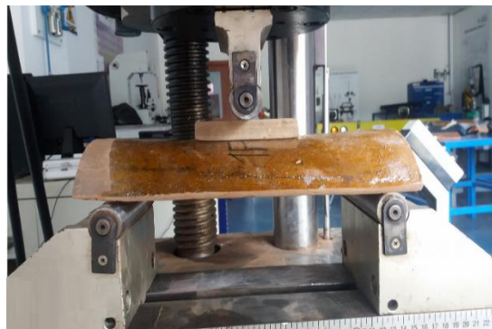
Figura 18. Muestra de teja cerámica en posición paralela al acople de madera.
