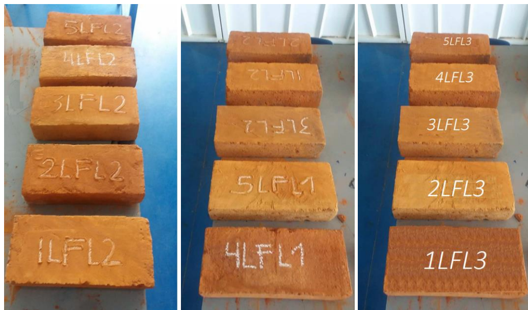
Figura 8. Ladrillos enteros codificados para ensayo de flexión.
