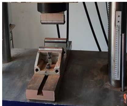
Figura 16. Bancada fija, con acoples cilíndricos en posición paralela.
