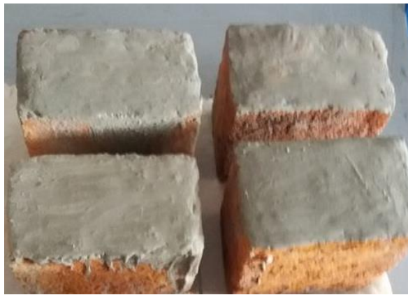
Figura 6. Recubrimiento de la capa de cemento Pórtland sobre las superficies de ladrillo con imperfecciones.
