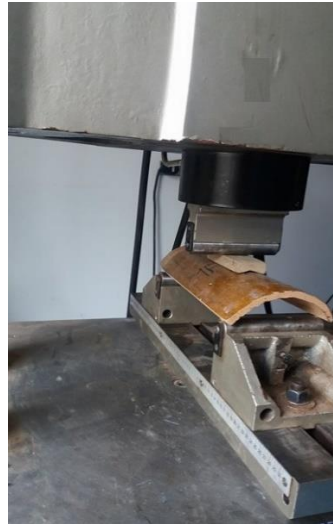
Figura 17. Acople de madera sobre el lomo de la teja cerámica.
