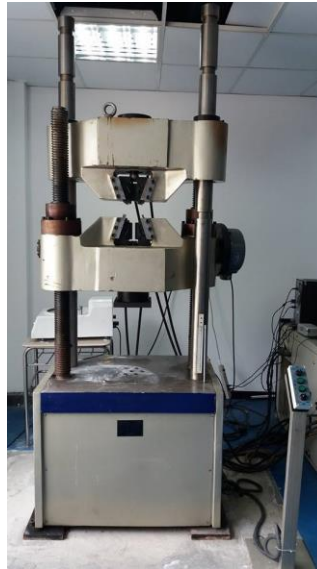
Figura 4. Máquina electro-hidráulica de ensayos universal para determinar la resistencia a la Compresión.
