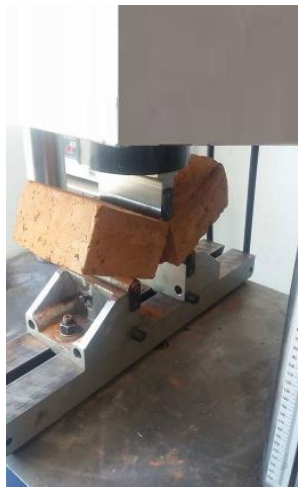
Figura 12. Fractura del ladrillo debida a la carga aplicada
