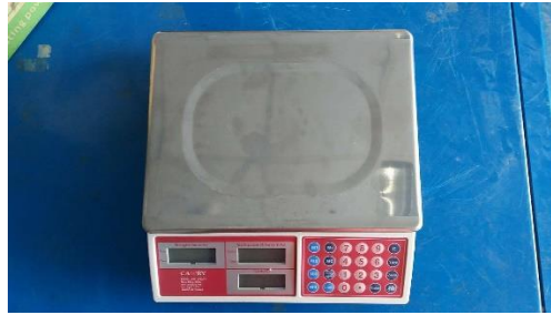
Figura 1. Balanza electrónica Camry, con capacidad máxima de 6000g,
