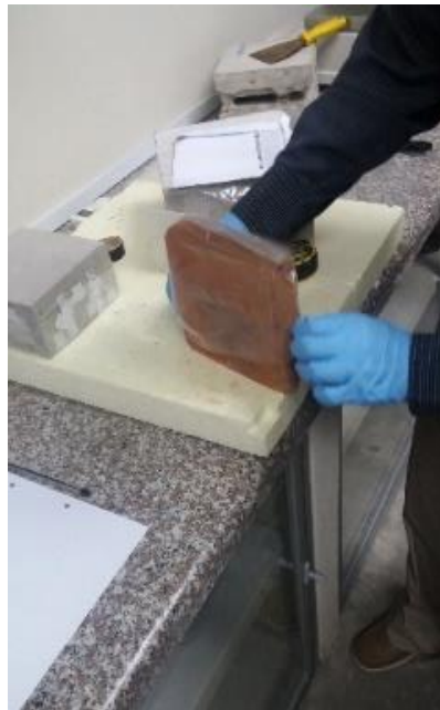
Figura 23. Colocación de recubrimiento de plástico a muestra de teja, ladrillo cerámica.
