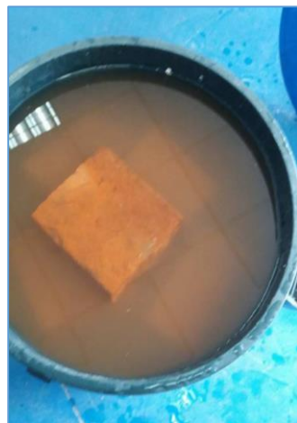
Figura 3. Probetas de ladrillo sumergidas en agua.
