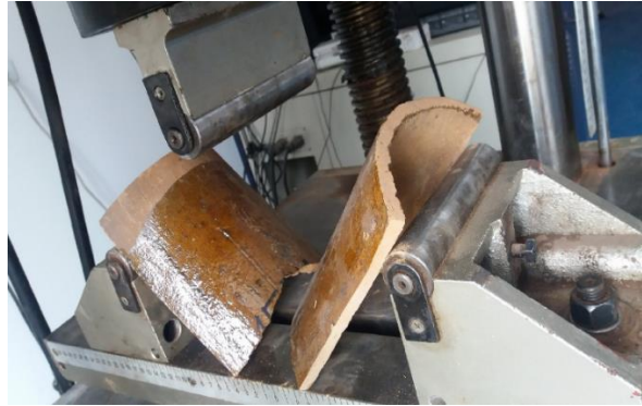
Figura 19. Rotura de la muestra de teja cerámica a la aplicación de la carga máxima admisible.
