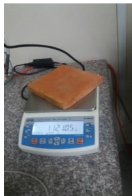
Figura 22. Recepción de datos de masa de la teja cerámica.
