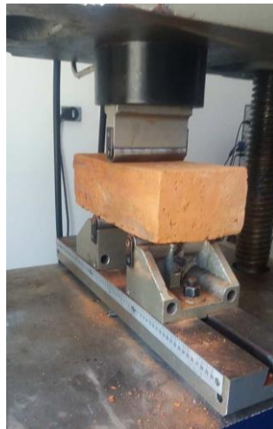
Figura 11. Ladrillo con la cara mayor sobre los apoyos fijos.
