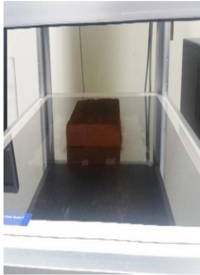
Figura 26. Muestra en posición educada según la norma ISO 8302.
