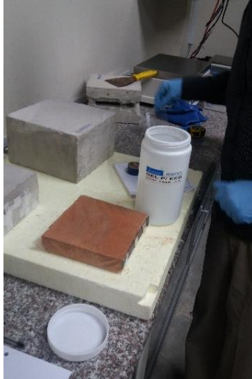
Figura 24. Colocación de gel ultrasónico en superficie de muestra.
