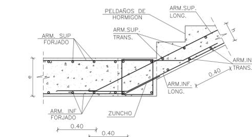
DETALLE 107 - ESCALERAS 01.02.03 - APOYO DE ZANCA EN FORJADO (ARRANQUE)
