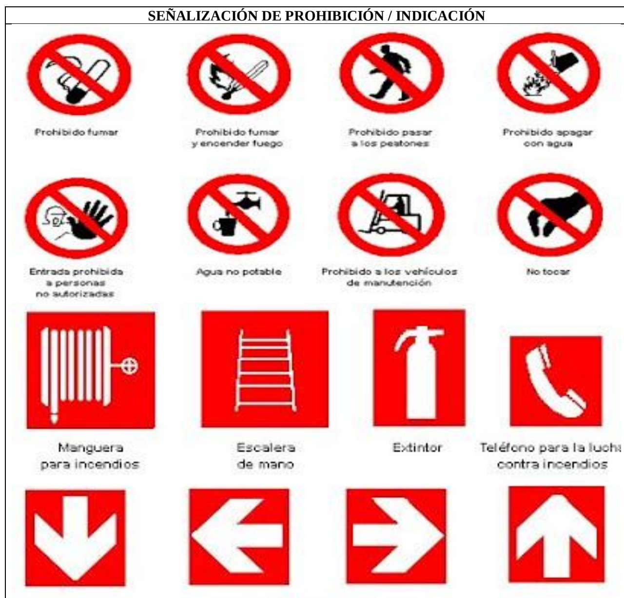
Figura 10 . Señalización de Prohibición / Indicación
