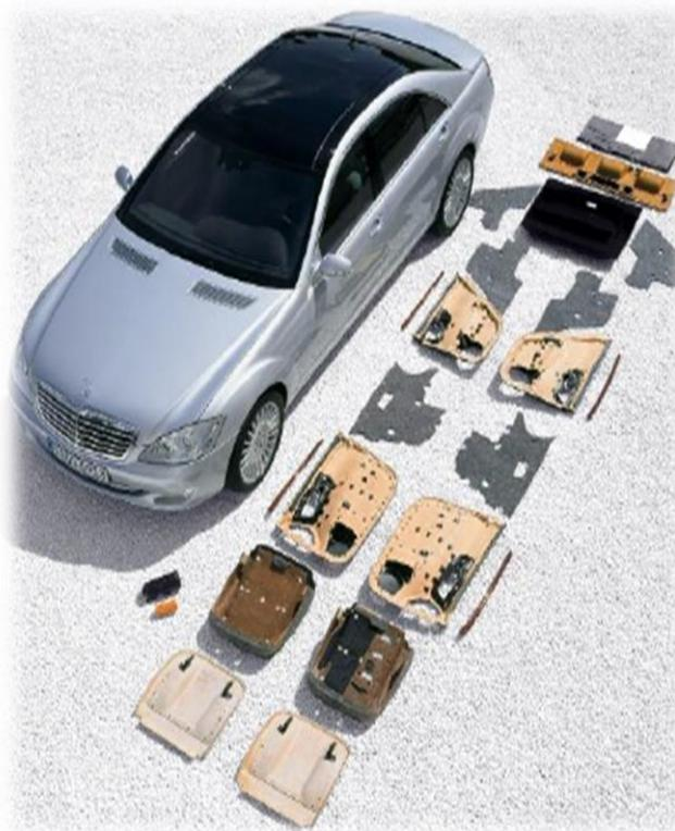
*Figura 4.* Autopartes del vehículo Mercedes Benz formado por fibras naturales.
