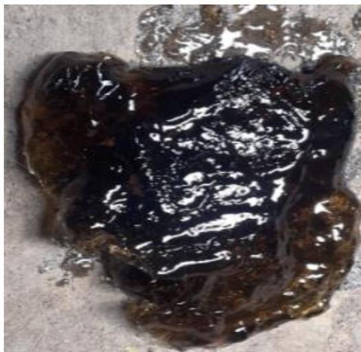
*Figura 39.* Proceso de gelificacion de la resina isoftálica.
