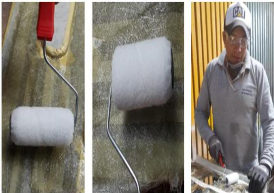
*Figura 50.* Aplicación de la fibra de vidrio.
