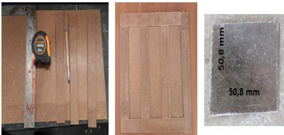
**Figura 33.** Molde para probetas e impacto norma ASTM D5628-10
