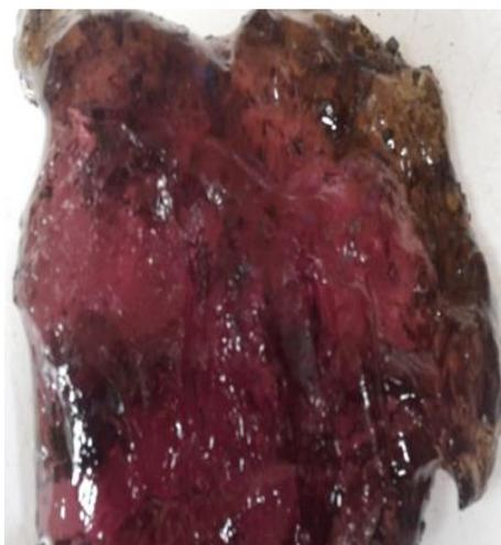
*Figura 40.* Proceso de endurecimiento dela resina isoftálica.
