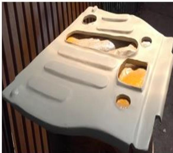
*Figura 57.* Aplicación de fondo de relleno automotriz.
