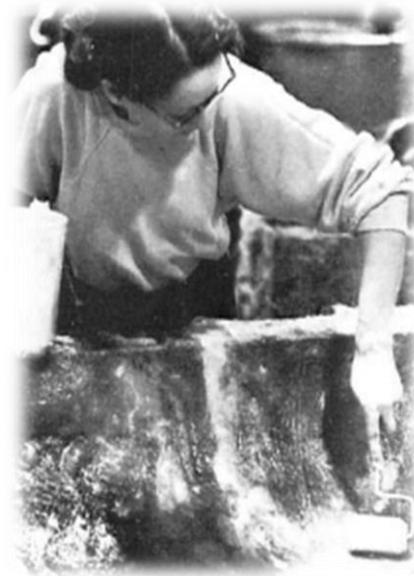
**Figura 21.** Técnicas de estratificación manual.
