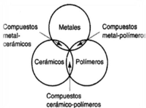
Figura 18. Tipos básicos de materiales y materiales compuestos.
