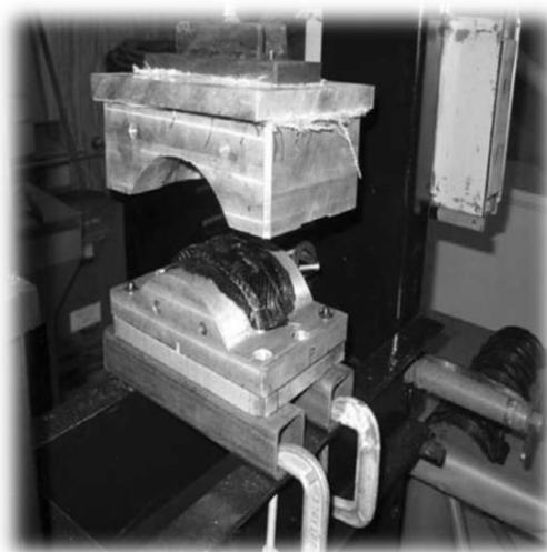
**Figura 28.** Moldeo por compresión.
