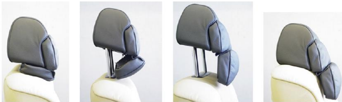
Figura 40. Reposacabezas con soporte de cuello en diferentes posiciones. Franz et al., 2012.
