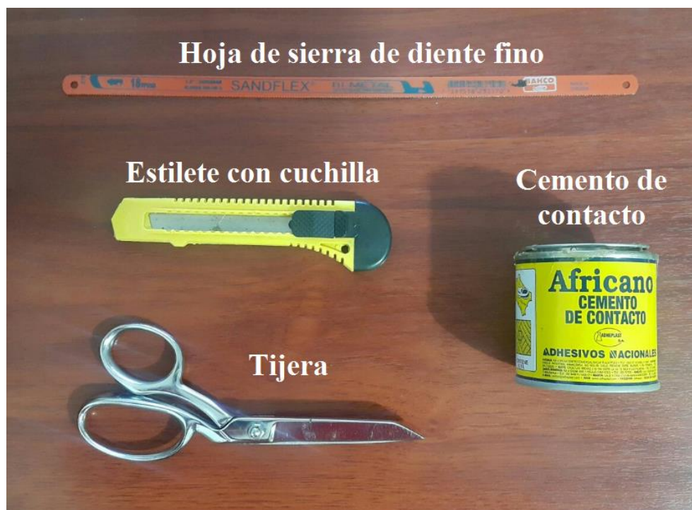
Figura 77. Materiales usados en el corte y posterior pegado de la espuma de poliuretano. Autor, 2018.
