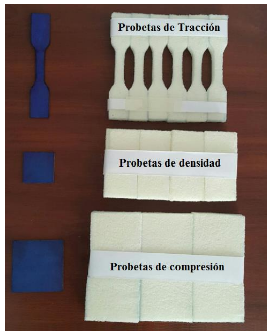
Figura 81. Probetas de espuma de poliuretano para ensayos mecánicos. Autor, 2018.
