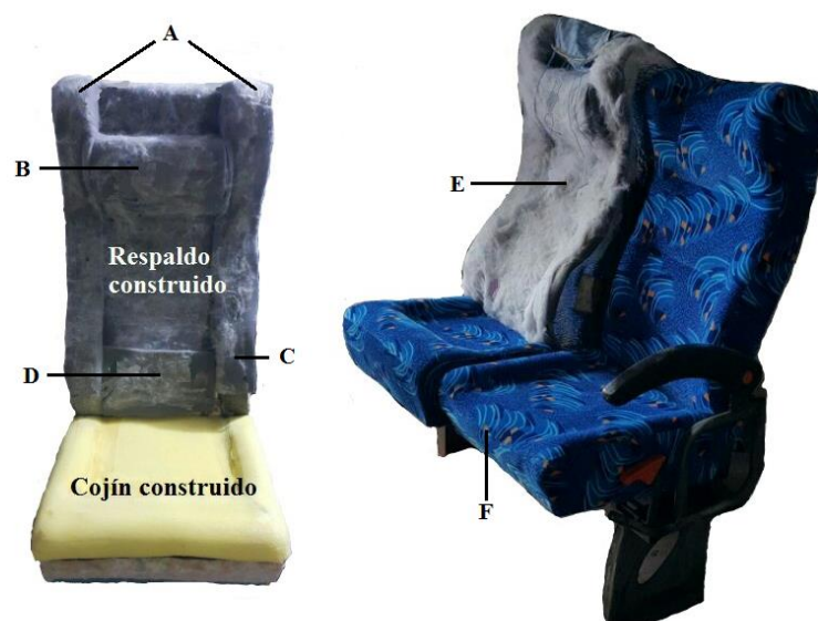
Leyenda: A: Soportes laterales del cráneo B: Soporte cervical C: Soporte lateral D: Soporte lumbar E: Asiento prototipo F: Asiento actual
