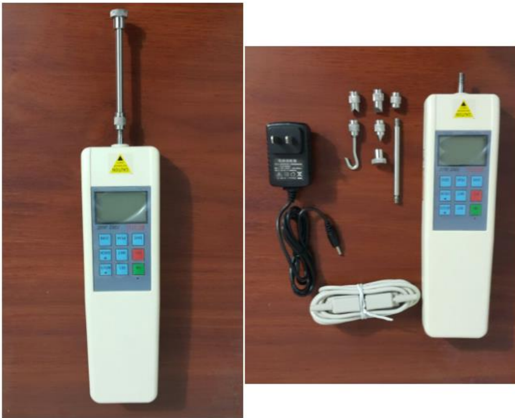
Figura 70. Medidor digital de fuerza de empuje, modelo HF-200 con accesorios (derecha) y armado para medir la fuerza de empuje (izquierda). Autor, 2018.
