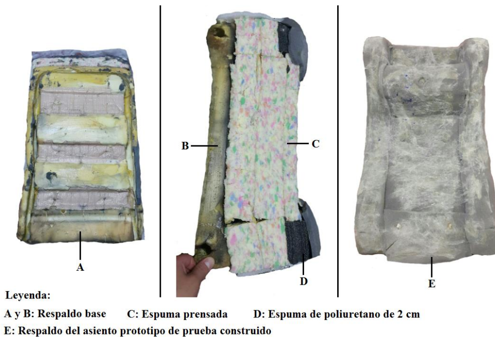
Figura 60. Construcción del respaldo del asiento prototipo de prueba. Espuma de poliuretano (A, B, D) y espuma prensada (C). Autor, 2018.
