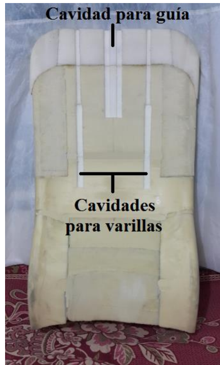
Figura 79. Cavitades realitzades sobre el respald de asient prototip final. Autor, 2018.
